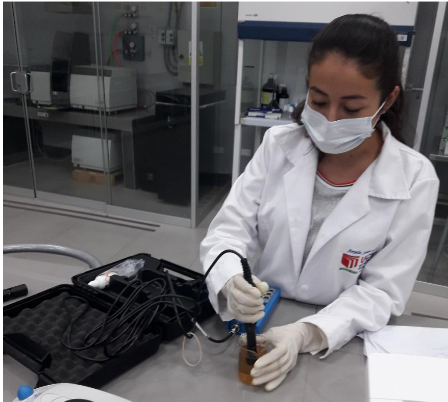
Figura N° 9: Analizando el oxígeno disuelto de la prueba control.
