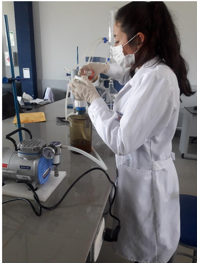
Figura N° 25: Filtrando las muestras de agua.
