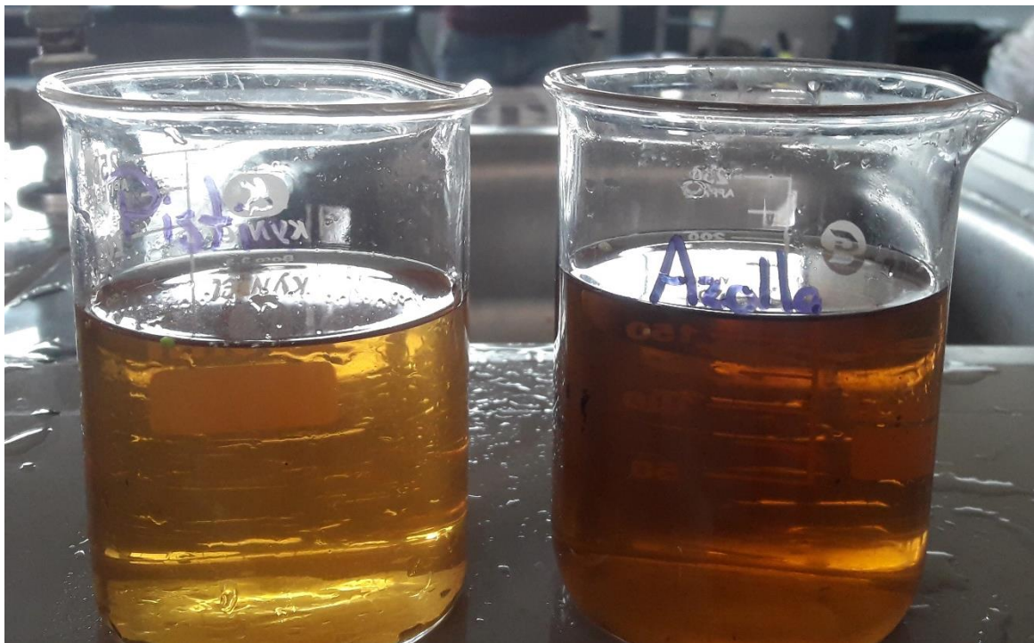
Figura N° 24: Muestras de agua residual tratada con las macrófitas a los 21 días.
