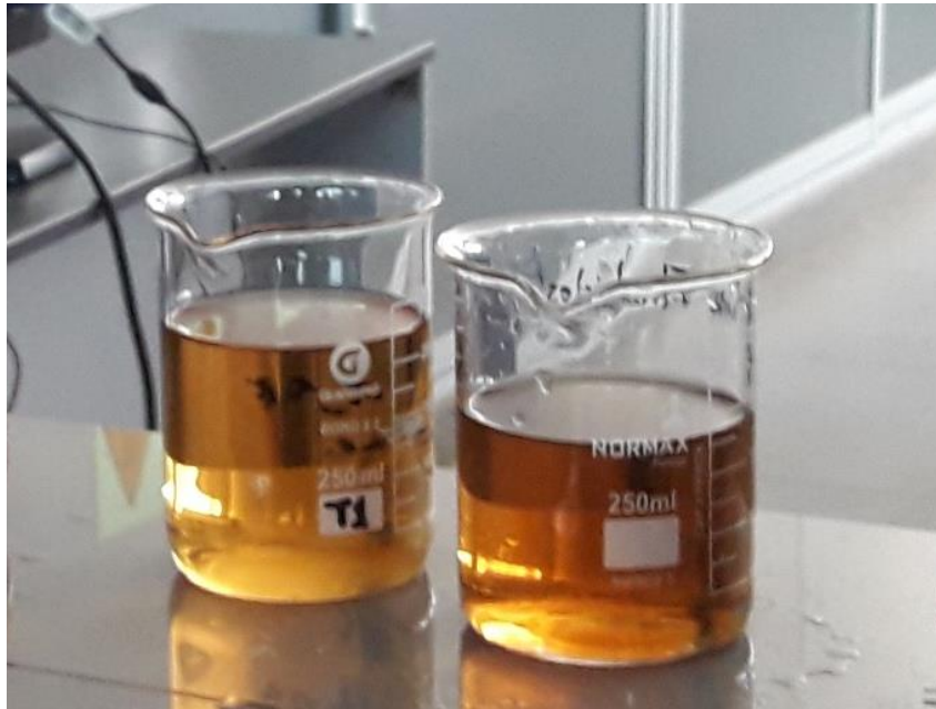
Figura N° 23: Muestras de agua residual tratada con las macrófitas a los 14 días.
