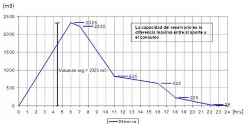
Figura 3. Grafica del volumen de regulación de un reservorio.
