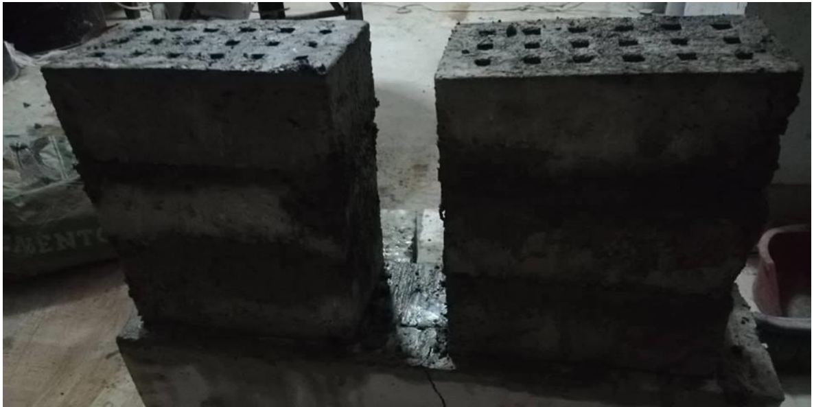
FOTO N° 22: Ensayo pilas: Se colocó 3 ladrillos en forma vertical con mortero de dosificación 1:1/2 para medir la resistencia a compresión axial F'm .
