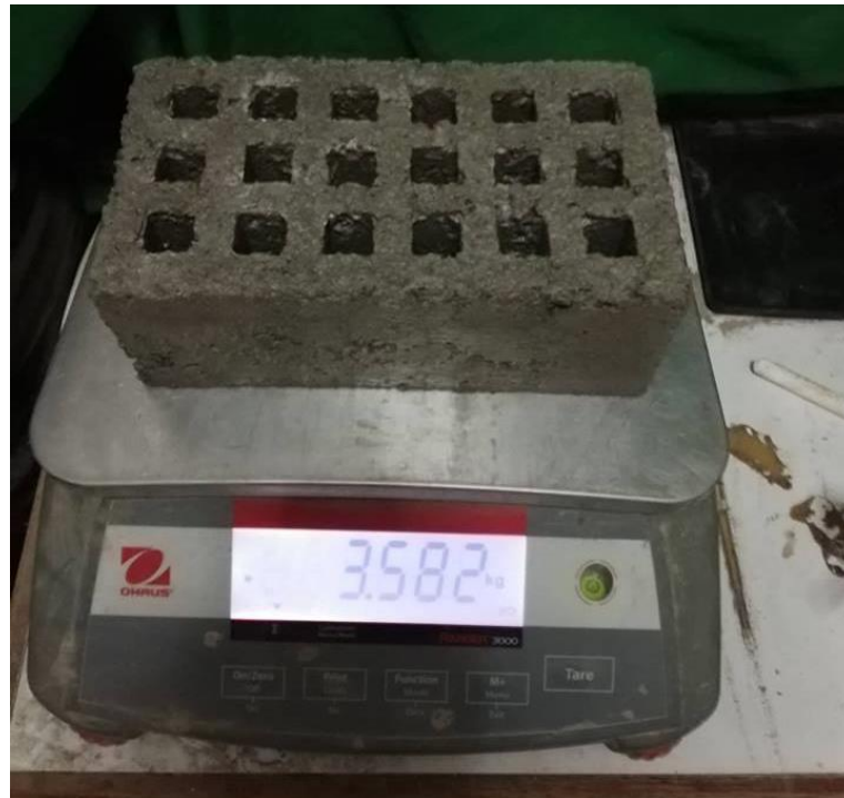
FOTO N° 23: Ensayo de absorción y contenido de humedad: La unidad estuvo en saturación por 24 para realizar el ensayo de absorción, el contenido de humedad se pesó en estado natural.
