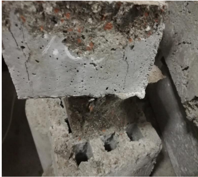
FOTO N° 19: Observación: Se puede apreciar los residuos sólidos después de la rotura en resistencia a la compresión.
