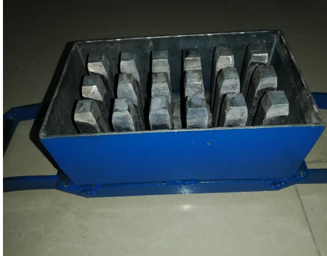
FOTO N°8: Ladrillo Hueco: Molde del ladrillo hueco de medida 22x12x8 cm, con un porcentaje de vacíos de 28.7 %, tiene 18 huecos que están asimétricamente separados
