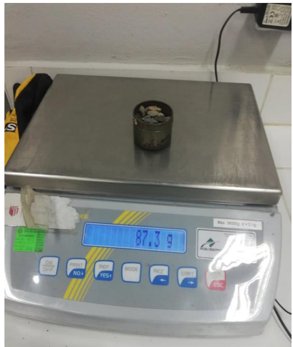
FOTO N°5: Porcentaje de humedad: Se realizó la selección de las muestras las cuales serán introducidas al horno para obtener el porcentaje de humedad del material
