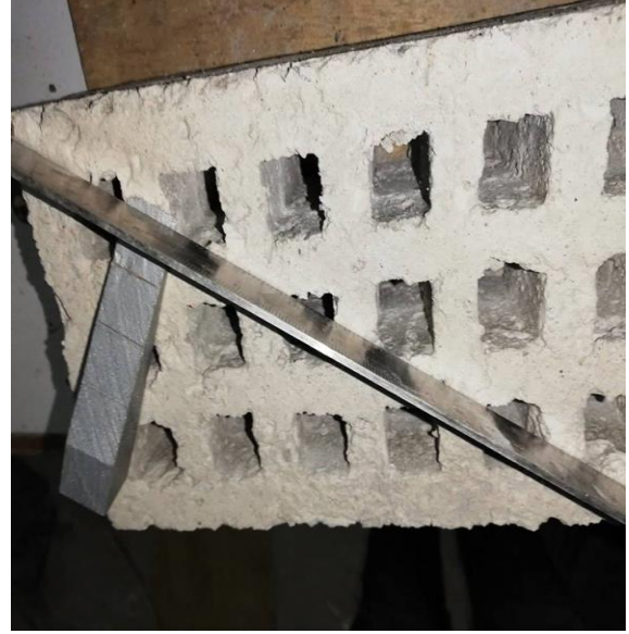
FOTO N° 21: Ensayo alabeo: Este ensayo tiene la finalidad de conocer la convexidad y concavidad de la unidad de albañilería. Todo depende de la cuña milimetrada, donde se puede apreciar cuanto ingresa por la regla puesta en diagonal.
