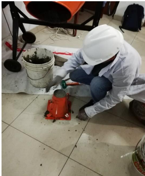
FOTO N° 11: Prueba de revenimiento: Se rellenó de concreto el cono de Abrams para ver el revenimiento que tiene y de esa manera conocer el porcentaje de agua.
