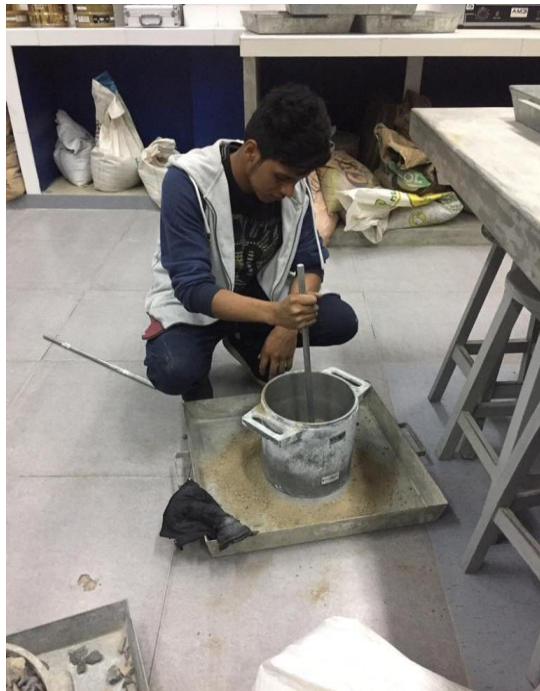
FOTO N°4: Análisis de peso unitario suelto y compactado de los agregados
