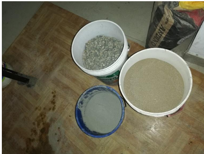
FOTO N°9: Dosificación Patrón – 0 %: Se realizó el pesaje de cemento, arena y confitillo según el diseño de mezcla para la elaboración del ladrillo patrón
