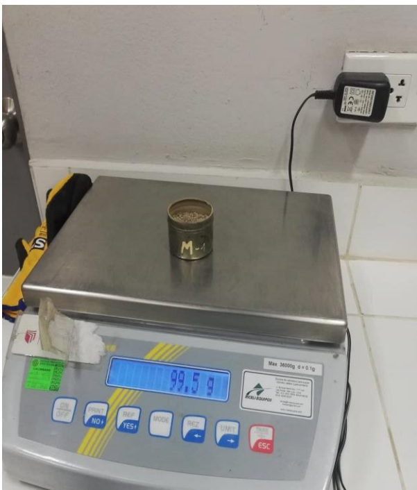
FOTO N°5: Porcentaje de humedad: Se realizó la selección de las muestras las cuales serán introducidas al horno para obtener el porcentaje de humedad del material
