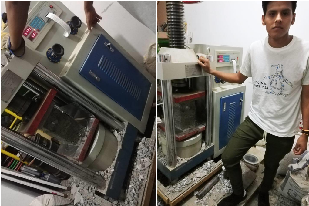
FOTO N° 25: Resistencia a compresión axial: Los ladrillos en pilas se sometieron ante cargas verticales en la compresora.
