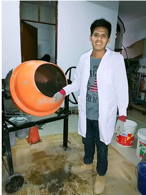
FOTO N°10: Mezcladora: Es una mezcladora tipo trompito, esta debe estar libre de partículas y humedecida antes del trabajo. Se introdujo todo el material deliberadamente según los procesos de mezcla.
