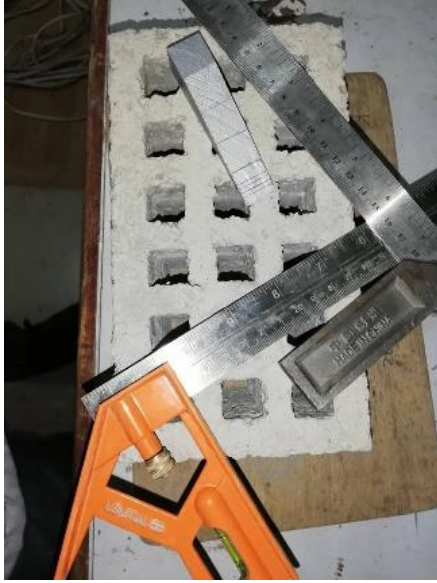
FOTO N° 21: Ensayo alabeo: Este ensayo tiene la finalidad de conocer la convexidad y concavidad de la unidad de albañilería. Todo depende de la cuña milimetrada, donde se puede apreciar cuanto ingresa por la regla puesta en diagonal.
