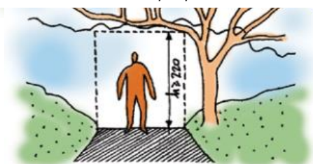
Figura 19. Altura mínima Fuente: Manual de parques accesibles
