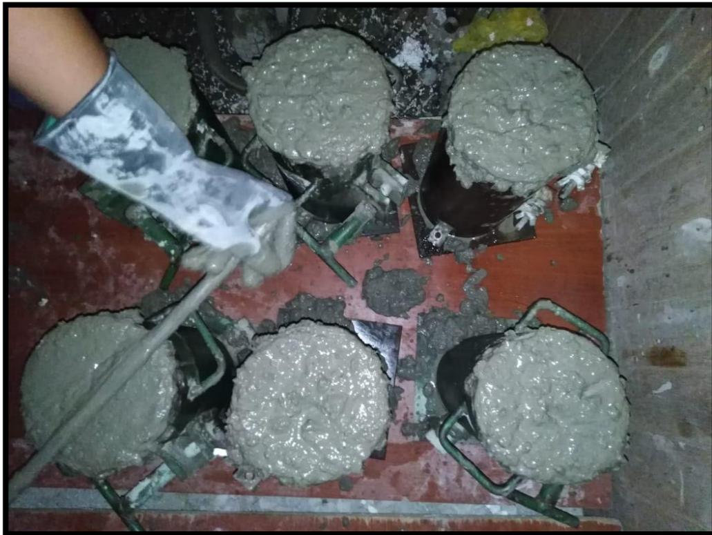
Preparación de probetas
