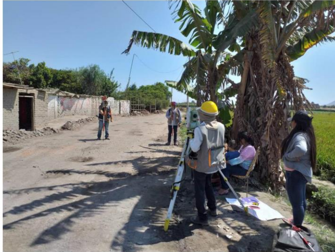
IMAGEN 05: Toma de puntos del ancho de la red vial vecinal con la estación total.
