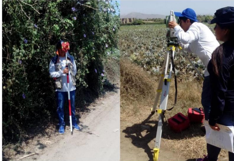
Foto N° 01: Trabajo de campo con Estación Total LEICA.
