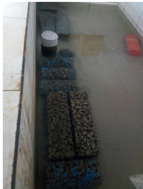
FOTOGRAFÍA 20: PROCESO DE CURADO DE LAS PROBETAS Y VIGAS DE CONCRETO PERMEABLE.
