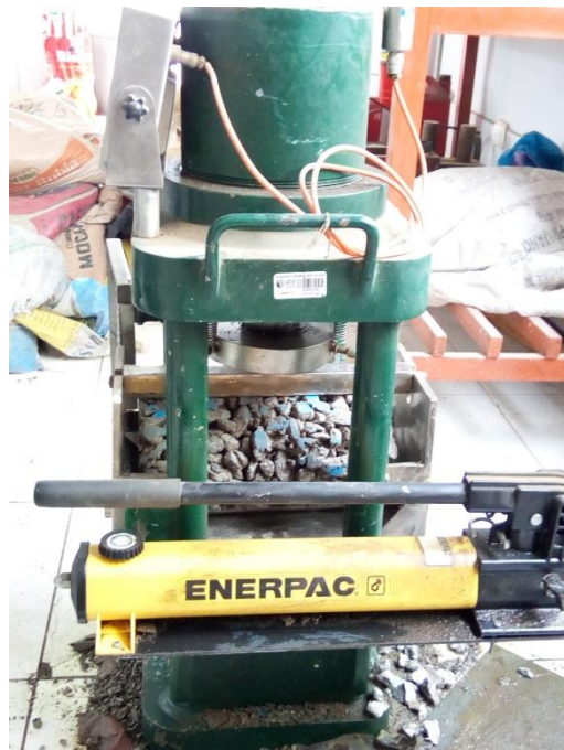
FOTOGRAFÍA 24: ROTURA DE PROBETA PARA EL ENSAYO DE RESISTENCIA A LA TRACCIÓN.
