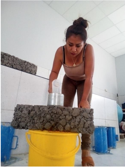
FOTOGRAFÍA 21: ENSAYO DE INFILTRACIÓN.
