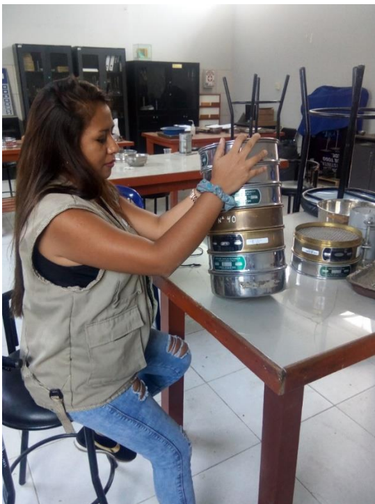
FOTOGRAFÍA 11: ANÁLISIS GRANULUMÉTRICO DE CADA MUESTRA PREVIAMENTE SECA.
