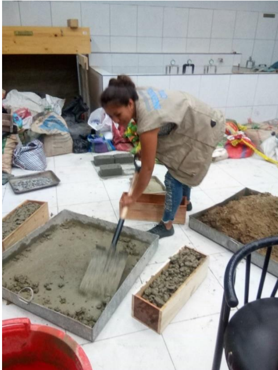
FOTOGRAFÍA 17: REALIZANDO LAS VIGAS DE CONCRETO PERMEABLE PARA EL ENSAYO RESISTENCIA A LA FLEXIÓN.
