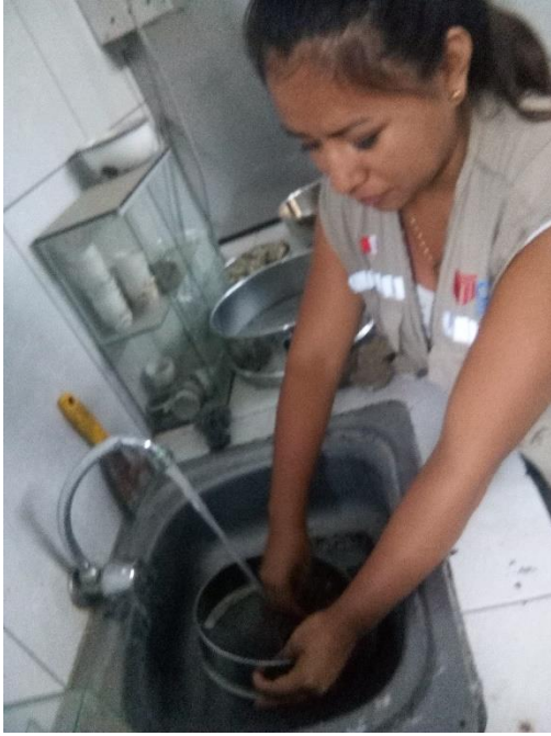
FOTOGRAFÍA 9: LAVADO DE MUESTRAS OBTENIDA DE LA EXPLORACIÓN DE SUELO.
