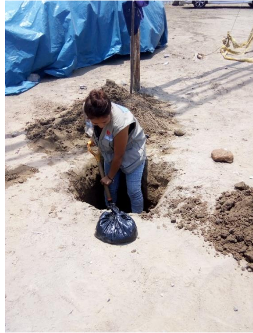
FOTOGRAFÍA 6: CALICATA N°2 DE LA AVENIDA PACÍFICO, TRAMO: EL CRUCE P.PAO - AV.PORTUARIA
