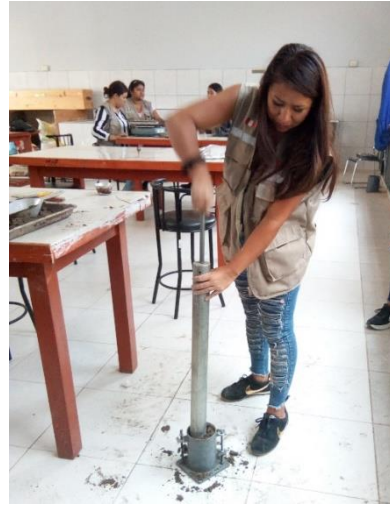
FOTOGRAFÍA 14: REALIZANDO EL ENSAYO DE PROCTOR.
