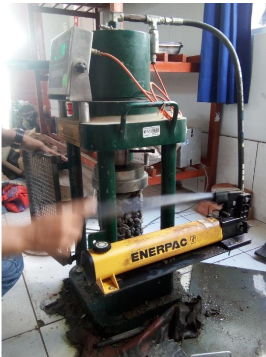
FOTOGRAFÍA 23: ROTURA DE PROBETA PARA EL ENSAYO DE RESISTENCIA A LA COMPRESIÓN.
