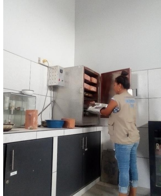
FOTOGRAFÍA 10: COLOCACIÓN DE LAS MUESTRAS LAVADAS EN EL HORNO ELECTRICO POR 24 HR
