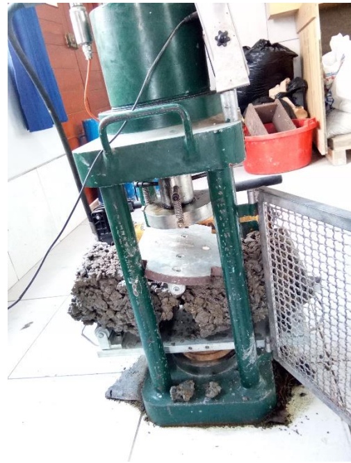
FOTOGRAFÍA 22: ROTURA DE VIGA DE CONCRETO PERMEABLE PARA EL ENSAYO DE RESISTENCIA A LA FLEXIÓN.
