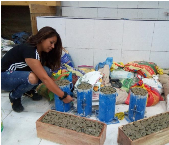
FOTOGRAFÍA 19: DESENCOFRANDO LAS PROBETAS Y VIGAS DE CONCRETO PERMEABLE PARA SU CURADO DE 7, 14 Y 28 DÍAS.
