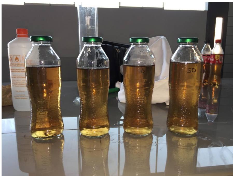
Figura N° 12: Análisis del pH, temperatura, turbidez y C.E. de los cuatro tratamientos después de 21 días.
