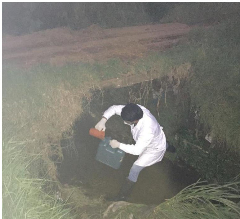
Figura N° 05: Toma de muestras de los puntos más críticos del tragadero Yacuchingana para ser tratadas con las biomásas de Eichhornia crassipes .
