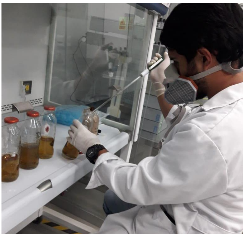
Figura N° 13: Colocación de ácido nítrico al 65 % a todas las muestras para ser conservadas y trasladadas al laboratorio de SEDALIB.
