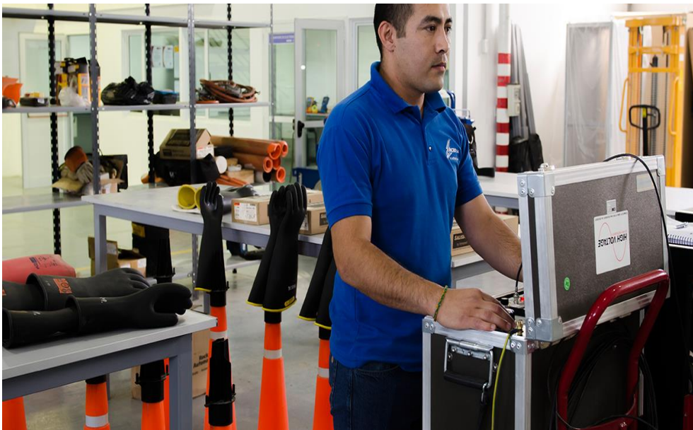
Figura 8: representación de un ensayo dieléctrico a guantes de media tensión.
