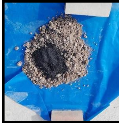
Figura 12 Suelo mezclado con Biocarbón 20%
