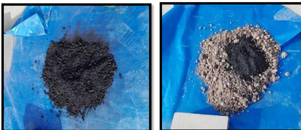
Figura 10 Suelo mezclado con Biocarbón 5%
