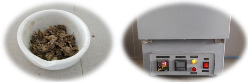
Figura 5 Carbonización de Excretas Porcinas
