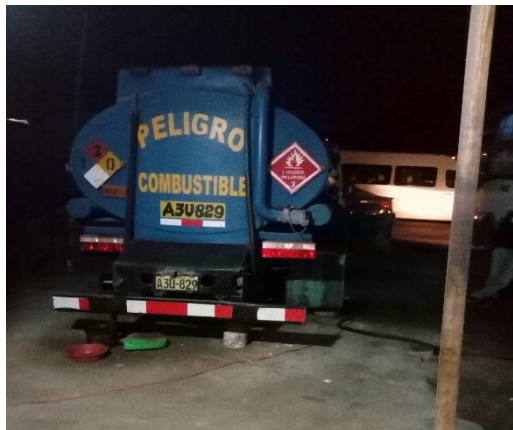
Figura 39. Señalización en la cisterna
