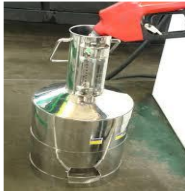
Figura 27. Medición con el serafín
