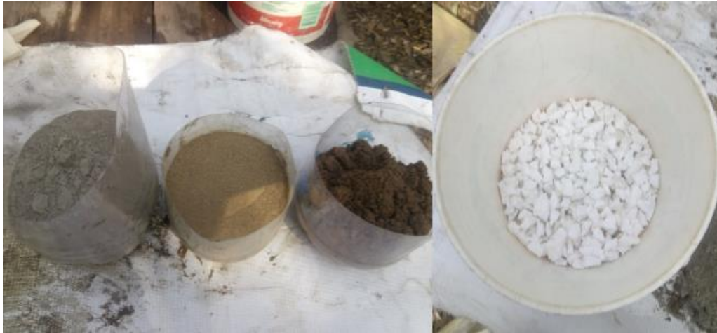
Figura 7. Muestra de cemento, relave, arena y poliestireno expandido (tecnopor)
