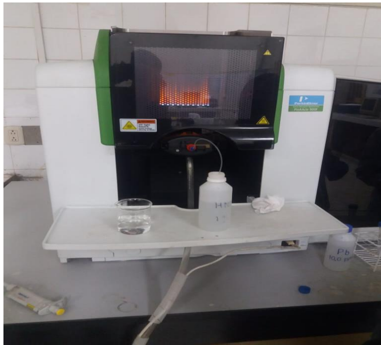
Imagen 9: Determinación de la concentración final de Pb (II) por método Espectrometría de absorción atómica
