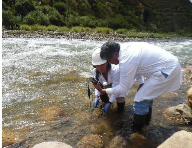
Fotografía 3. Colocación del sensor
