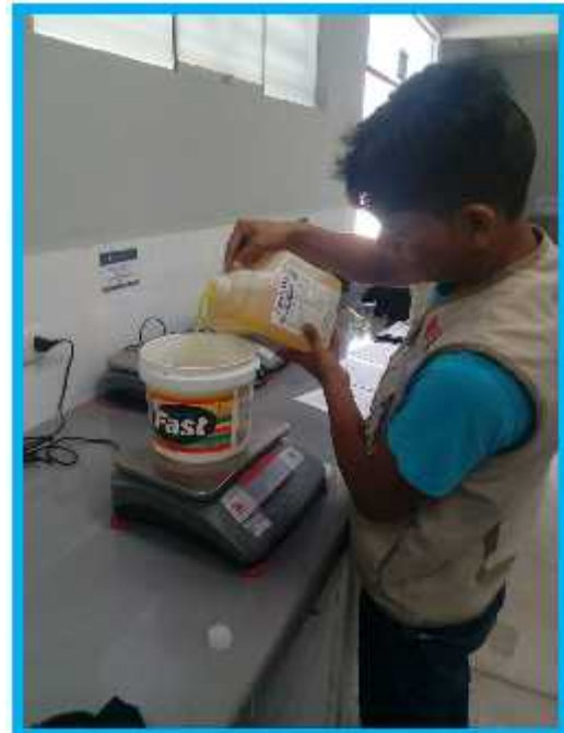
Pesado del aditivo Z fragua N° 5, para adicionarlo a la mezcla.
