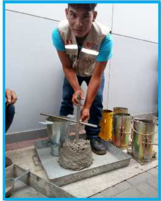
Medición del asentamiento del concreto, slump.
