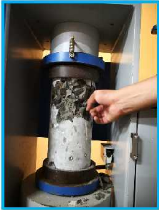
Rotura de probeta, falla frágil.
