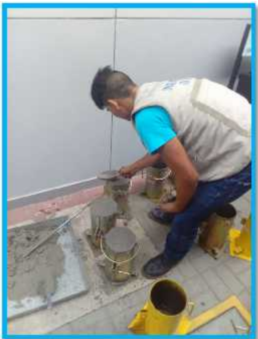
Enrase a las probetas llenas con mezcla de concreto.
