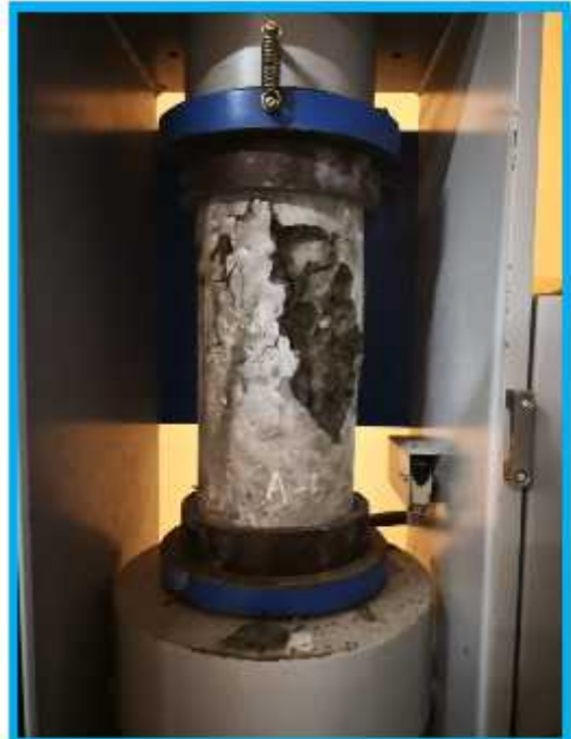
Rotura de probeta, falla dúctil.
