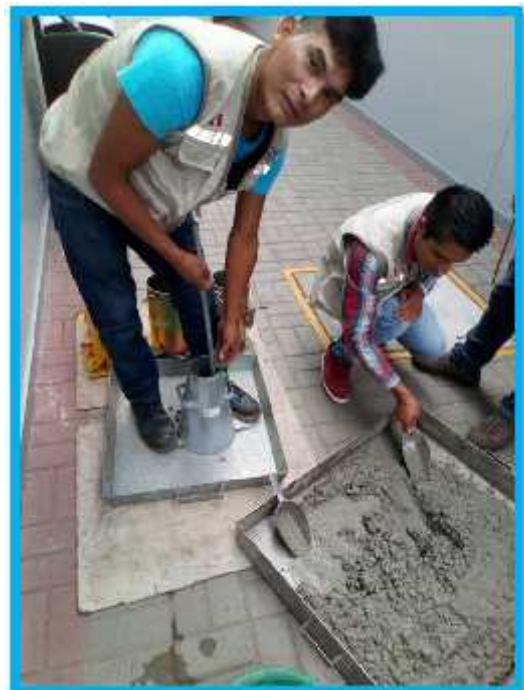
Cono de Abrams, para medir el slump.
