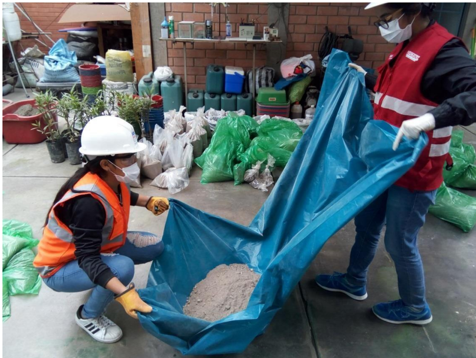
Ilustración 47. Metodo del cuarteo en Laboratorio.
