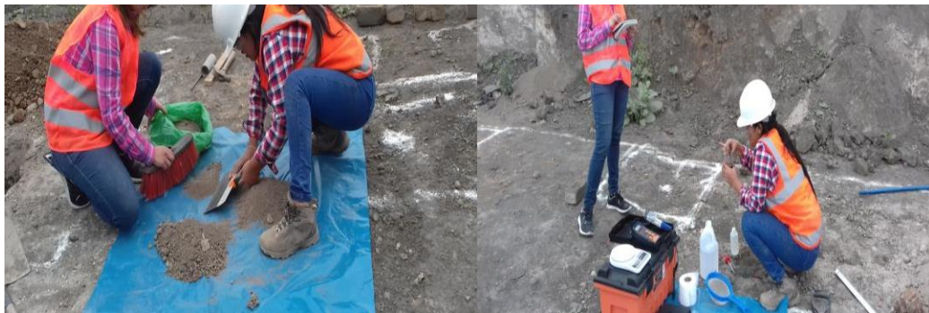
Ilustración 19. Cuarteo y lectura de parámetros in situ.
