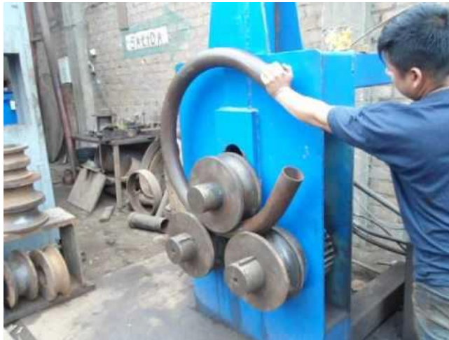
Rolado de tubos
