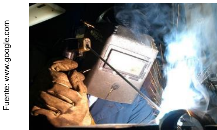
Soldadura por arco eléctrico
