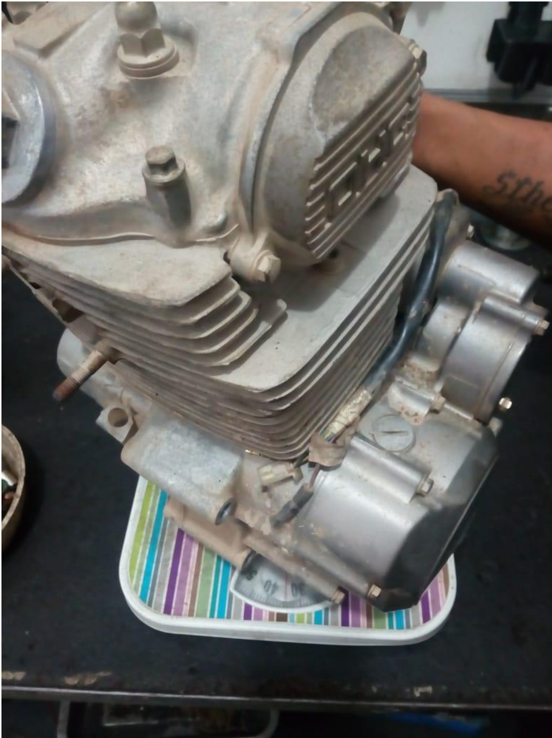
Proceso de toma de peso de motores para realizar los cálculos del soporte.
