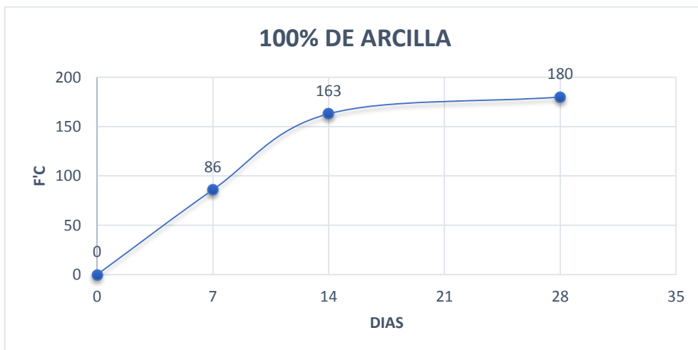
Figura 18. Ensayo de la resistencia a la compresión de 7, 14 y 28 días a las probetas de 100% de arcilla.
