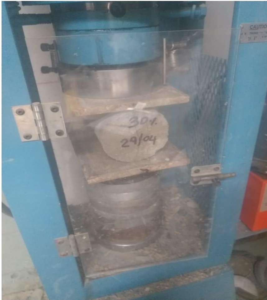
Figura 19. Resistencia a tracción por compresión diametral.
