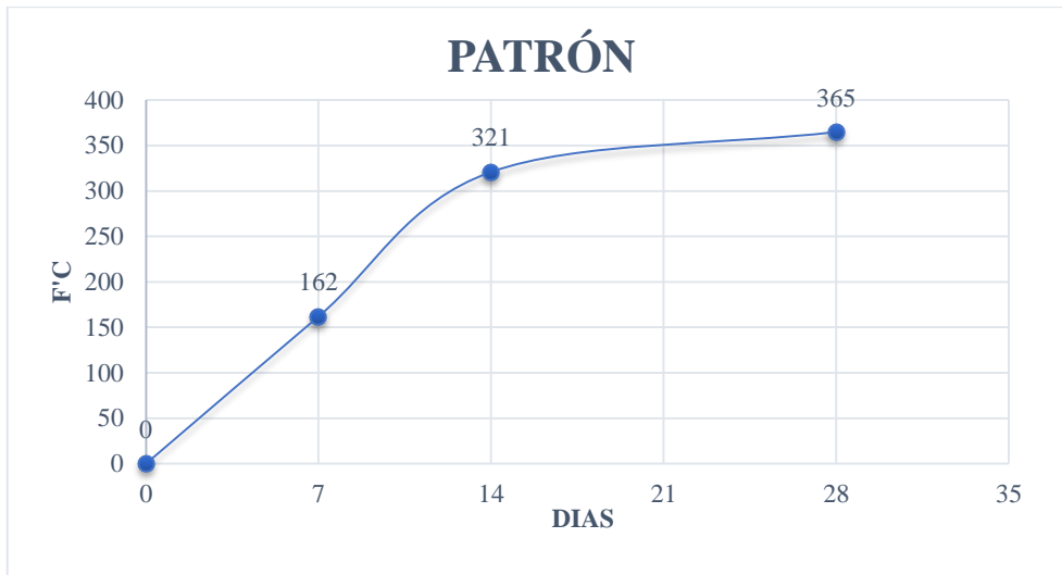
Figura 15. Ensayo de resistencia a la compresión 7, 14 y 28 días de especímenes prisma rectangular de concreto patrón.
