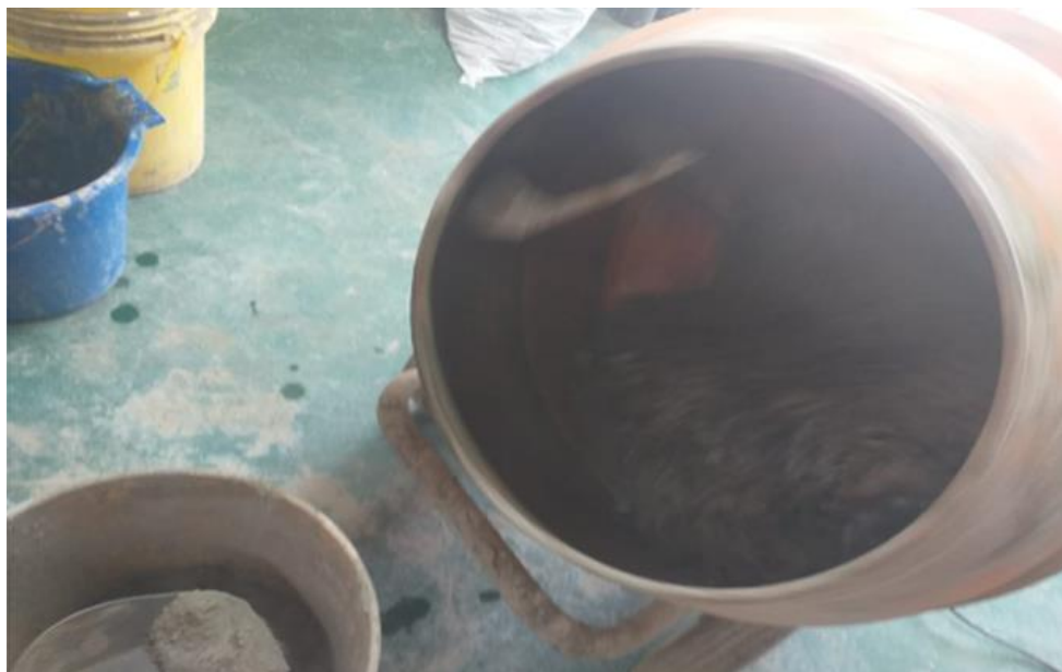
Figura 11. Diseño de mezcla con 30% de agregado grueso de arcilla
