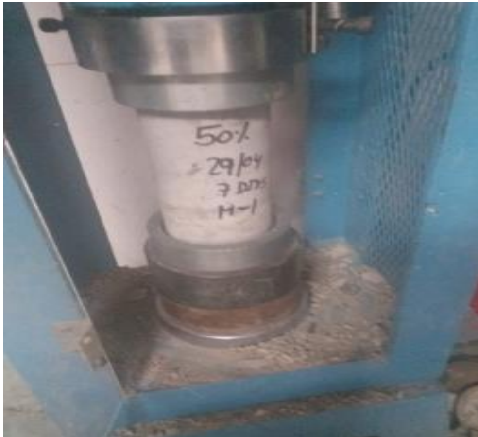
Figura 14. Ruptura a la compresión de probetas a los 14 días.
