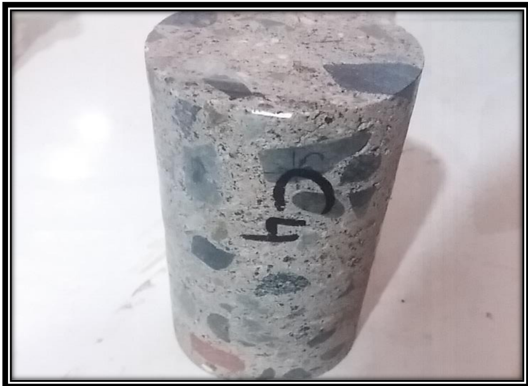
Figura 36: Testigo perfilado de la columna 4 F_y = 94 \text{ kg/cm}^2
