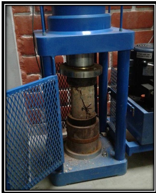
Figura 30: Máquina de rotura de testigos.
