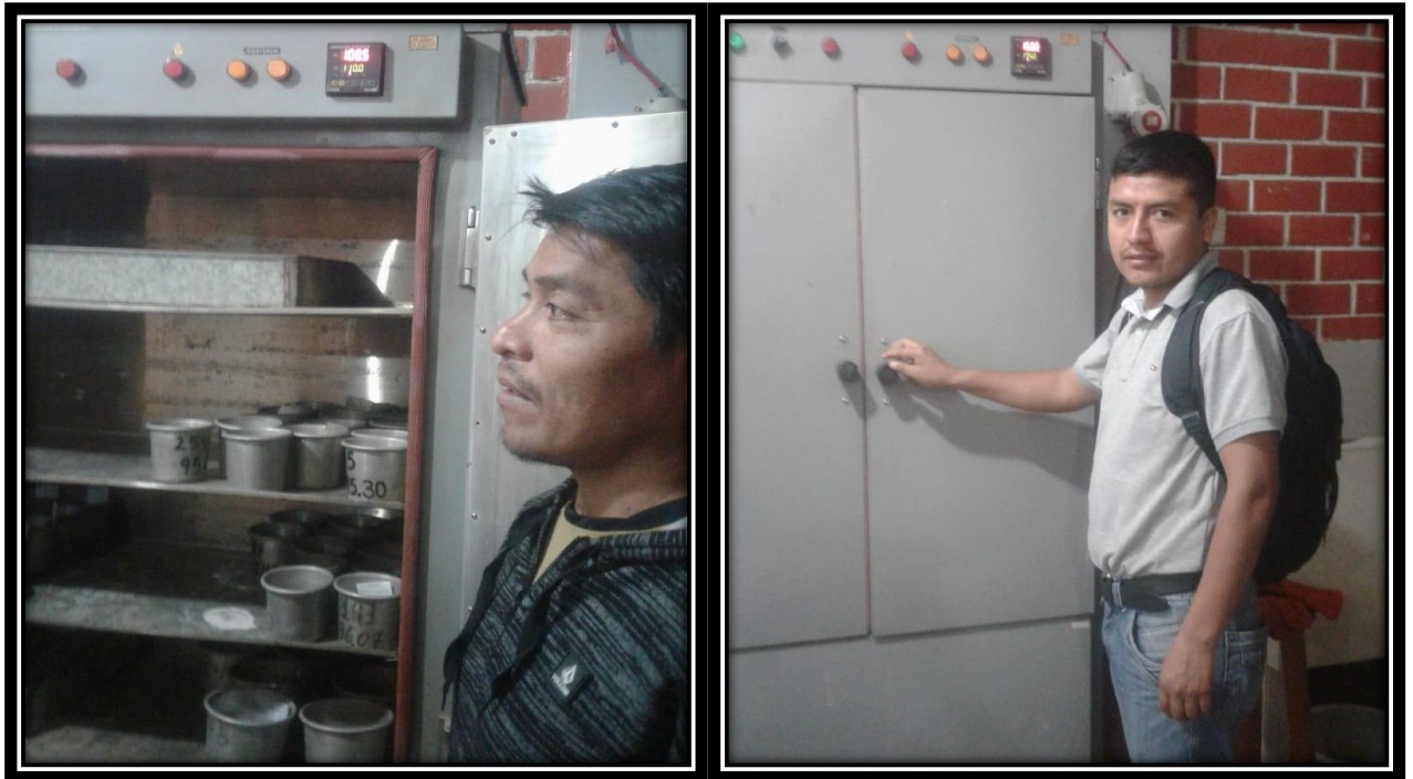
Figura 17: secado del suelo en el horno.
