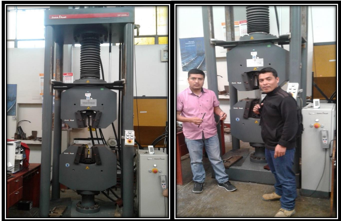
Figura 38: Máquina de ensayo uniaxial ZWICK/ ROELL.
