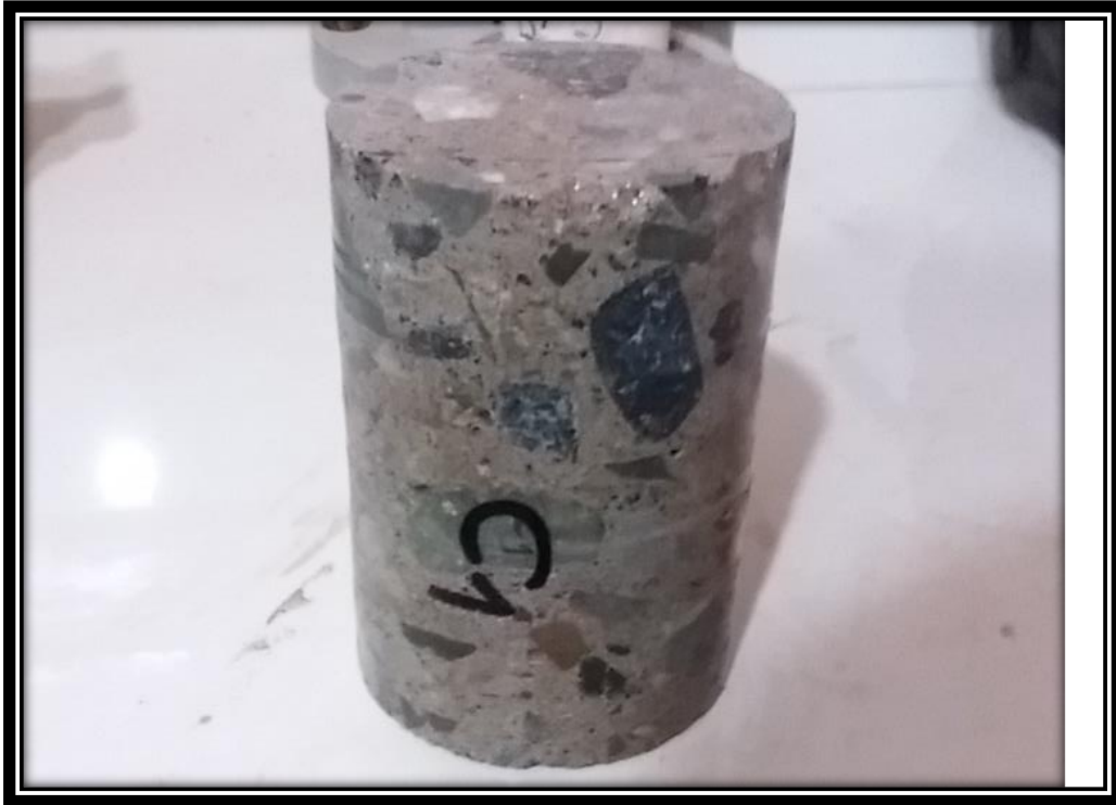
Figura 33: Testigo perfilado de la columna 1 F_y = 159 \text{ kg/cm}^2
