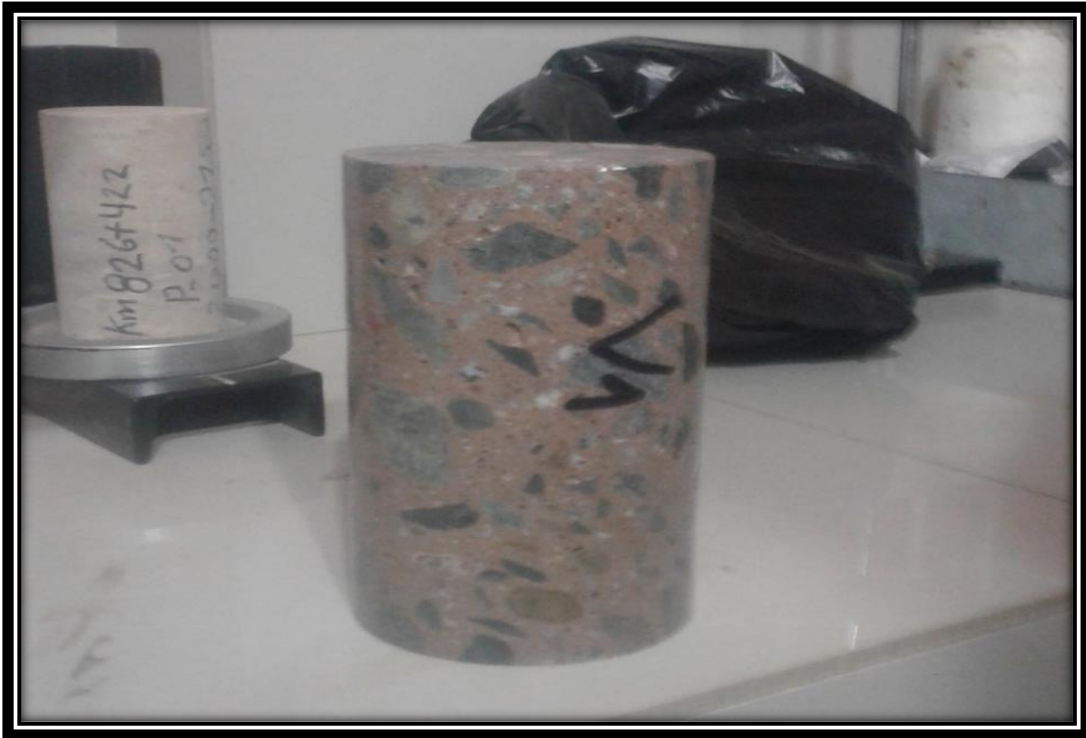
Figura 31: Testigo perfilado de la viga 1 F_y = 135 \text{ kg/cm}^2
