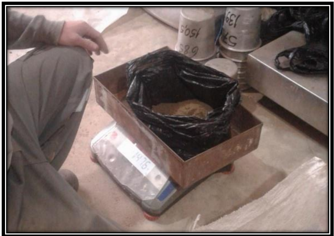
Figura 16: Realizando el peso del suelo para los ensayos
