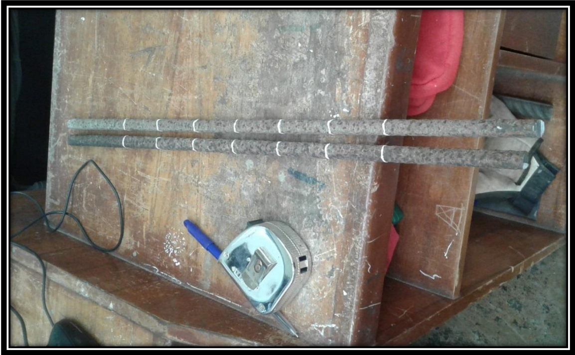
Figura 37: Muestras del acero para ensayo a tracción.
