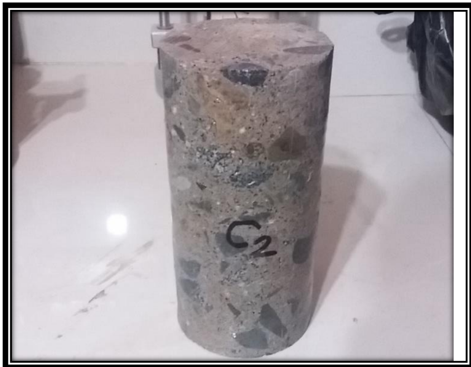
Figura 34: Testigo perfilado de la columna 2 F_y = 112 \text{ kg/cm}^2
