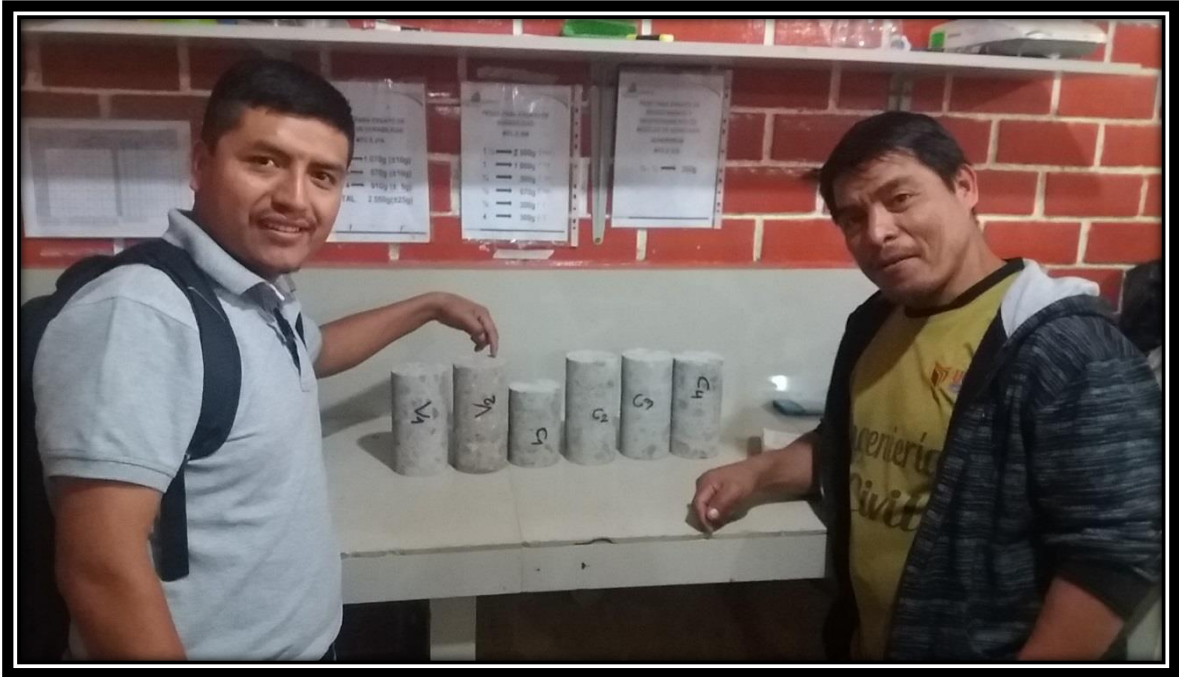
Figura 29: Muestras perfiladas listas para someter a rotura.
