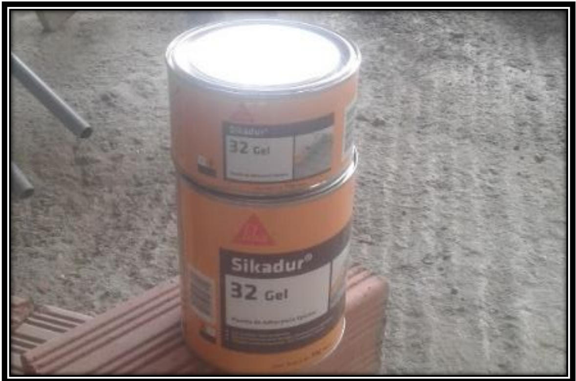
Figura 26: Material utilizado para unir concreto nuevo con el concreto viejo.
