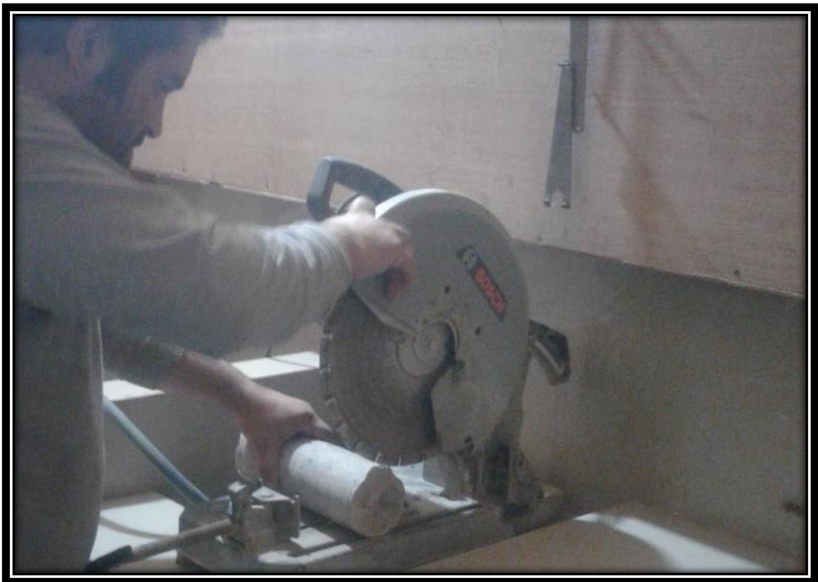
Figura 28: Perfilando los testigos en el laboratorio.
