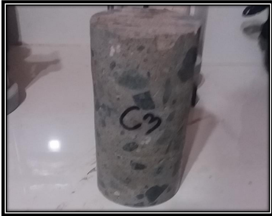
Figura 35: Testigo perfilado de la columna 3 F_y = 56 \text{ kg/cm}^2
