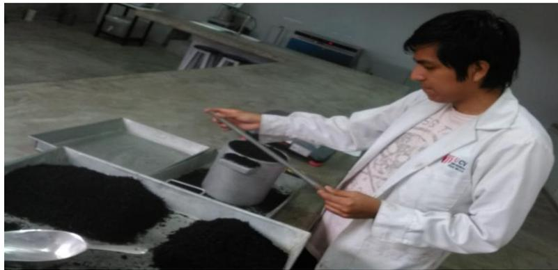
*Figura 40.* Enrasado del material suelto Fuente: Propia
