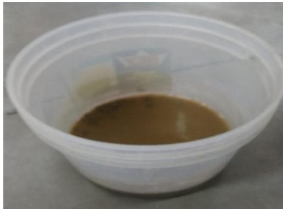
*Figura 17.* Saturación del agregado fino. Fuente: Propia
