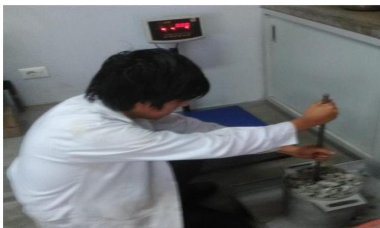
*Figura 27.* Varillado de la tercera capa del agregado fino. Fuente: Propia
