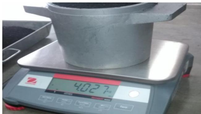
*Figura 43.* Peso número 2 del material de caucho compactado. Fuente: Propia
