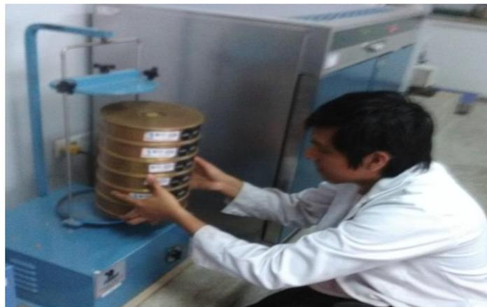
*Figura 22.* Colocación de las mallas del agregado grueso en el agitador mecánico. Fuente: Propia
