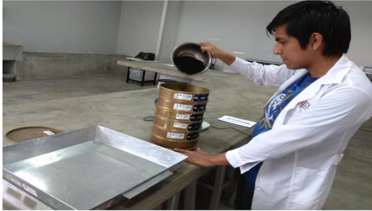
*Figura 34.* Colocación de la muestra en los tamices Fuente: Propia
