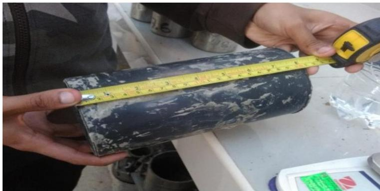
*Figura 51.* Medición de la longitud del molde de la probeta. Fuente: Propia
