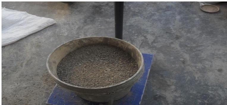
*Figura 62.* Cantidad de agregado fino a utilizar. Fuente: Propia
