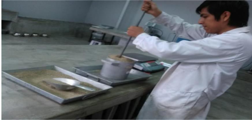
Figura 15. Varillado de la tercera capa del agregado fino. Fuente: Propia
