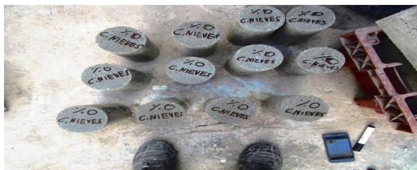
*Figura 68.* Desmolde de las probetas. Fuente: Propia.
