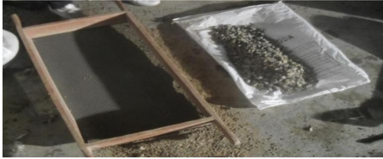
*Figura 61.* Tamizado del agregado grueso. Fuente: Propia
