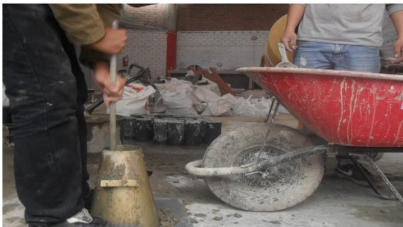
*Figura 58.* Calculo del Slump con incremento de 2.5 Lts de agua. Fuente: Propia.
