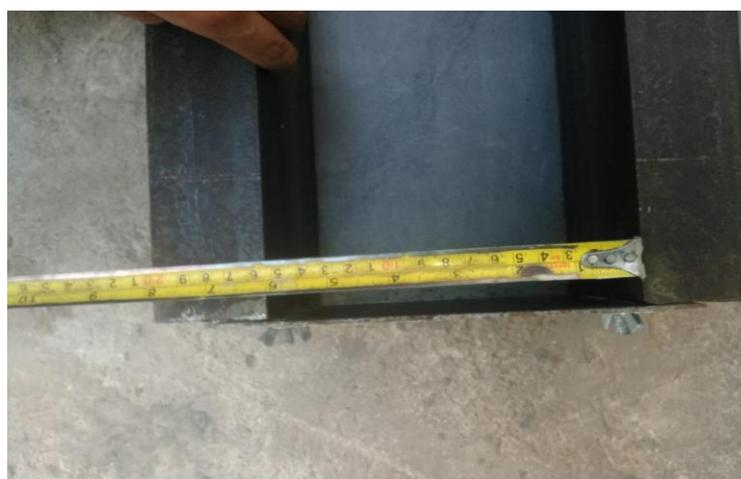
*Figura 53.* Medición del ancho de la viga. Fuente: Propia.
