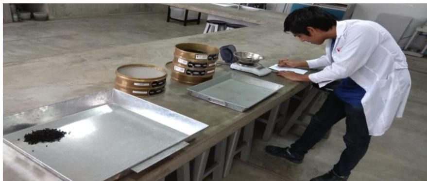
*Figura 36.* Calculo de la cantidad de material retenido en cada tamiz Fuente: Propia
