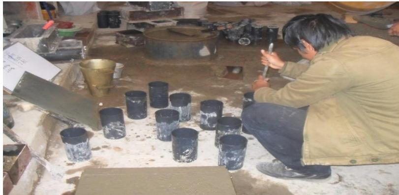
*Figura 66.* Varillado en la primera capa. Fuente: Propia.
