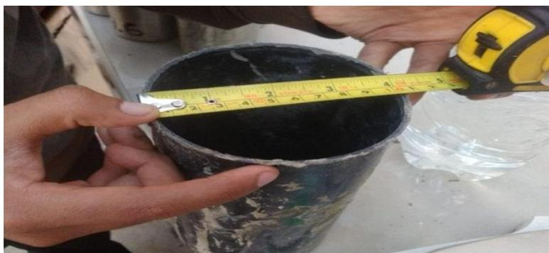
*Figura 52.* Medición del diámetro de la probeta. Fuente: Propia
