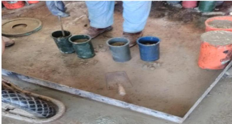
Figura 49: Colocación de la mezcla en 4 probetas de 10 cm x 20 cm. Fuente Propia
