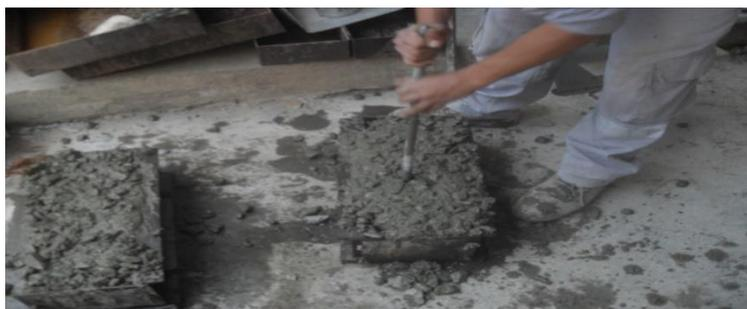
Figura 77: Varillados para la tercera capa de mezcla. Fuente: Propia
