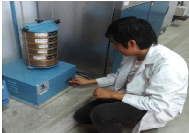
*Figura 11.* Colocación de las mallas del agregado fino en el agitador mecánico. Fuente: Propia
