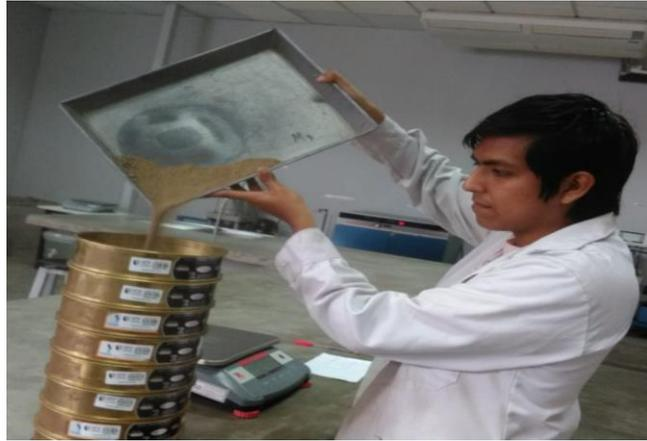
*Figura 10.* Colocación del agregado fino en la malla superior. Fuente: Propia
