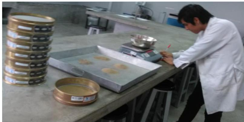
*Figura 12.* Tamizado del agregado fino. Fuente: Propia
