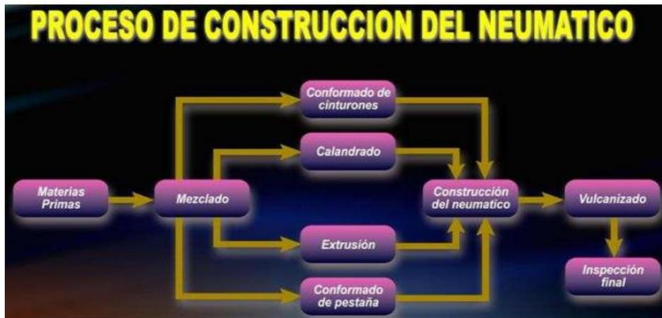
Figura 5. Proceso de construcción de un neumático, fuente: Castro (2008)
