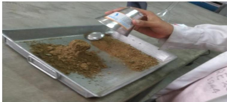
*Figura 19.* Desmoronamiento de la arena seca. Fuente: Propia
