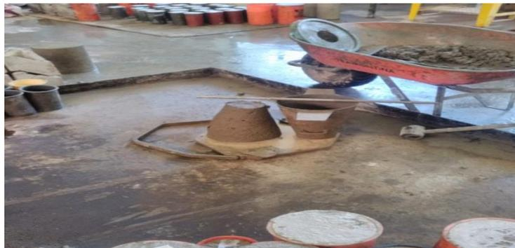
Figura 47: Desencofrado del cono de abrams. Fuente Propia
