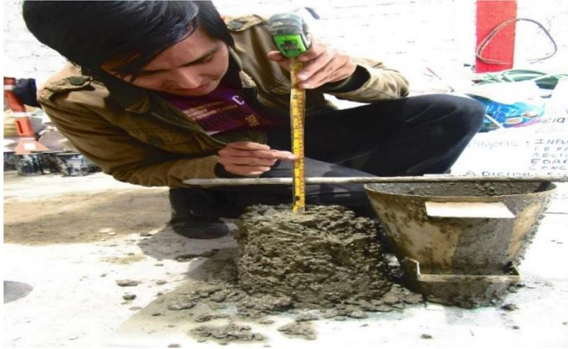
*Figura 59.* Medición del asentamiento del concreto. Fuente: Propia.
