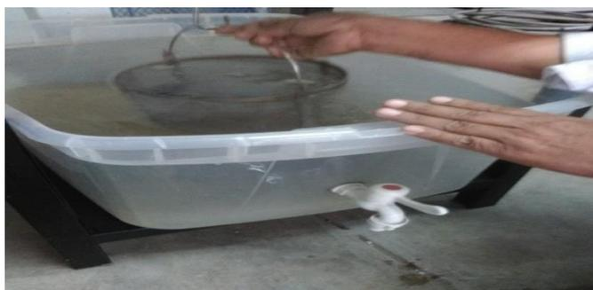
*Figura 30.* Colocación del agregado grueso en la canastilla. Fuente: Propia
