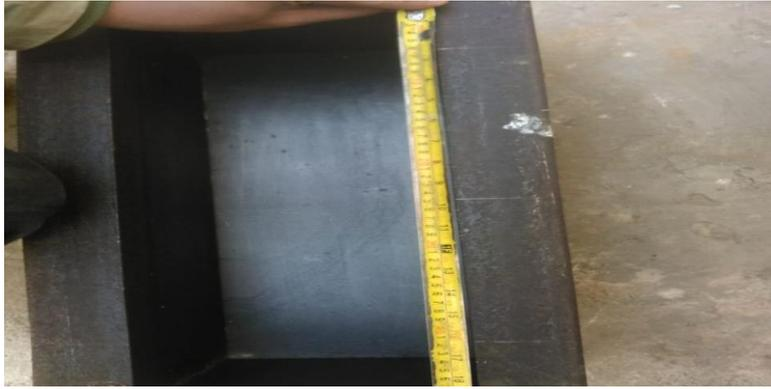
Figura 54. Medición de la longitud de la viga. Fuente: Propia.
