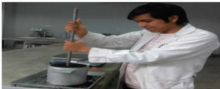
*Figura 42.* Varillado de la tercera capa del material de caucho. Fuente: Propia
