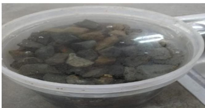
*Figura 28.* Agregado grueso en saturación. Fuente: Propia
