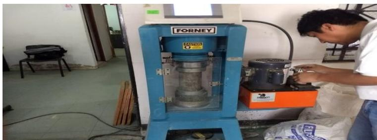
Figura 80. Rotura de la probeta a compresión. Fuente: Propia
