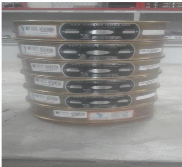
*Figura 8.* Tamices para el agregado fino. Fuente: Propia
