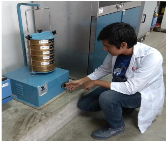
*Figura 35.* Agitador mecánico para el movimiento de los tamices Fuente: Propia
