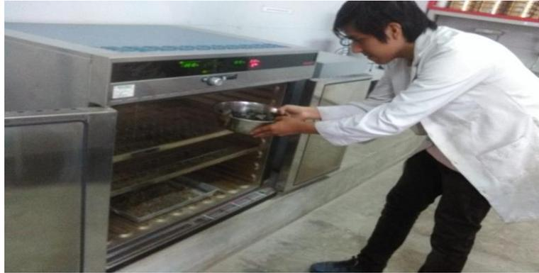
*Figura 21.* Colocación del agregado grueso al horno a  $110^{\circ}\text{C} \pm 5^{\circ}\text{C}$ . Fuente: Propia
