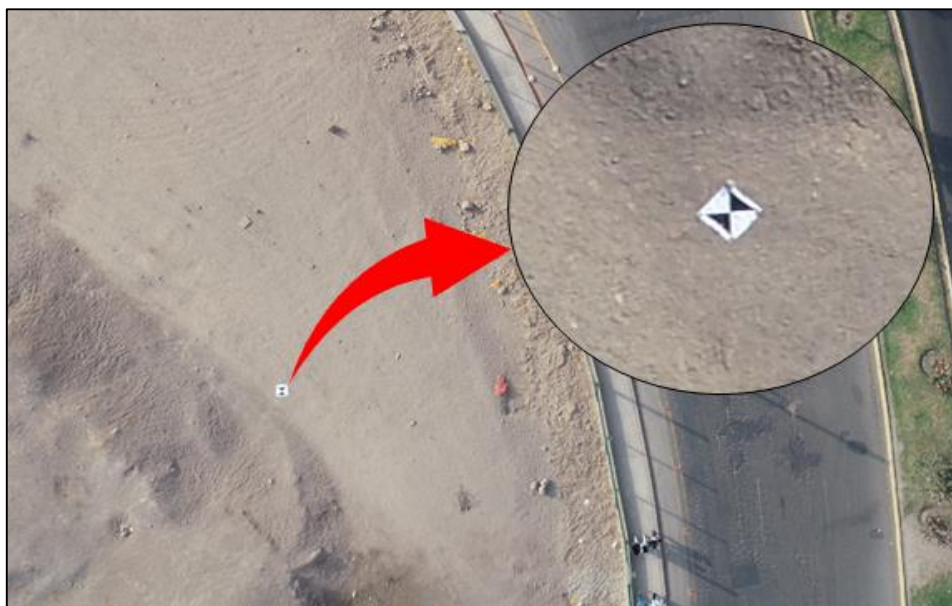
Figura 29. Punto fotocontrol en terreno del área del proyecto.
