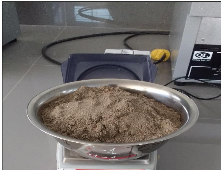
Figura 12: Peso de muestra seca una vez retirada del horno.
