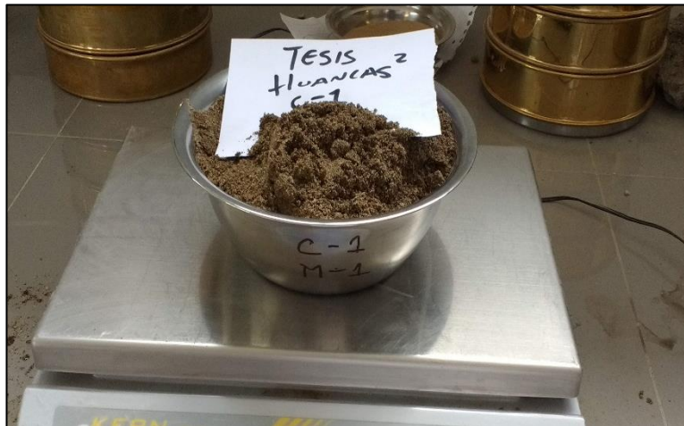
Figura 11: Peso de muestra extraída húmeda.
