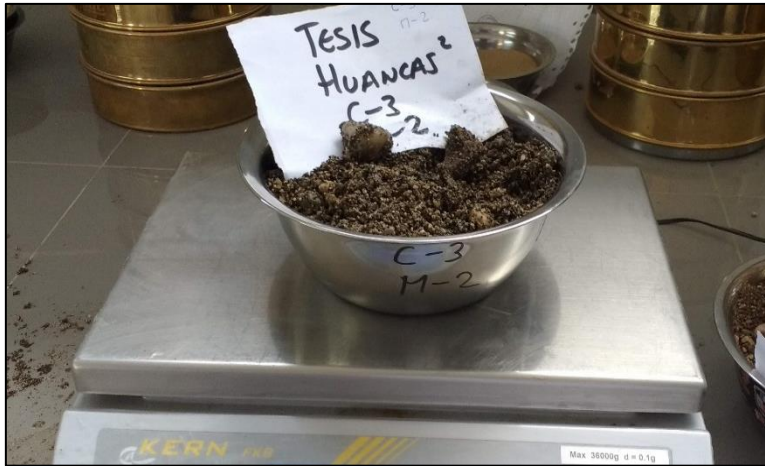
Figura 13: Peso de muestra extraída húmeda. Fuente: Elaboración propia.
