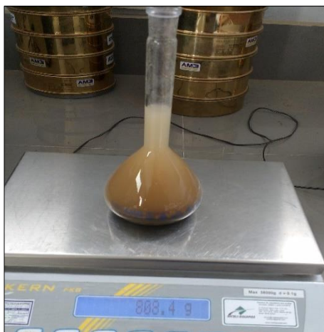
Figura 24: Peso de Fiola + agua + muestra. Fuente: Elaboración propia.
