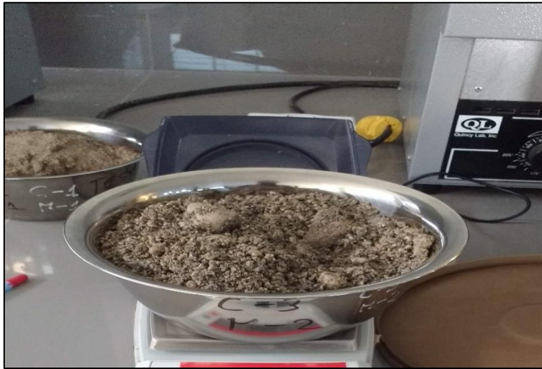
Figura 14: Peso de muestra seca una vez retirada del horno. Fuente: Elaboración propia.
