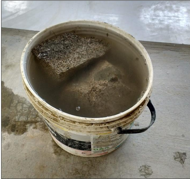
Figura 30: Saturación de la muestra por 24 horas. Fuente: Elaboración propia.
