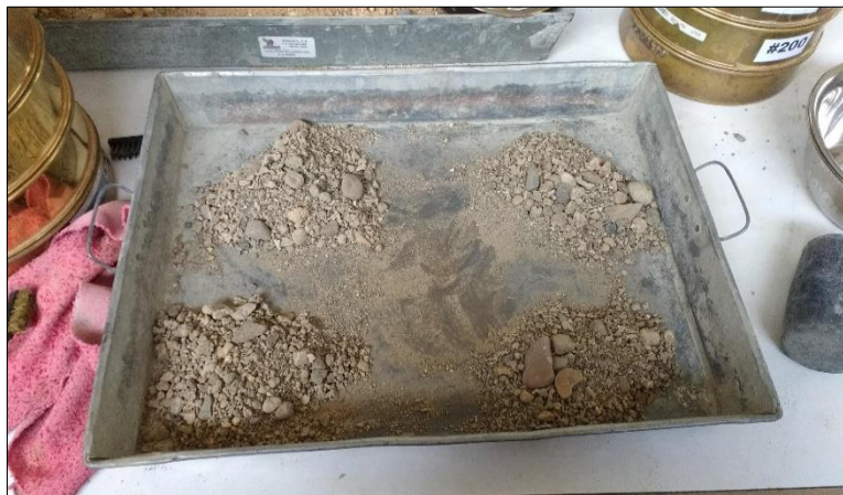
Figura 15: Cuarteo de muestra seca. Fuente: Elaboración propia.
