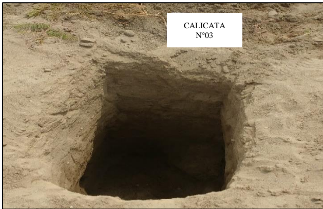
Figura 9: Excavación de la Calicata N°03. Fuente: Elaboración propia.
