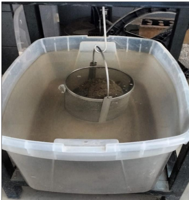
Figura 31: Saturación de la muestra por 24 horas. Fuente: Elaboración propia.
