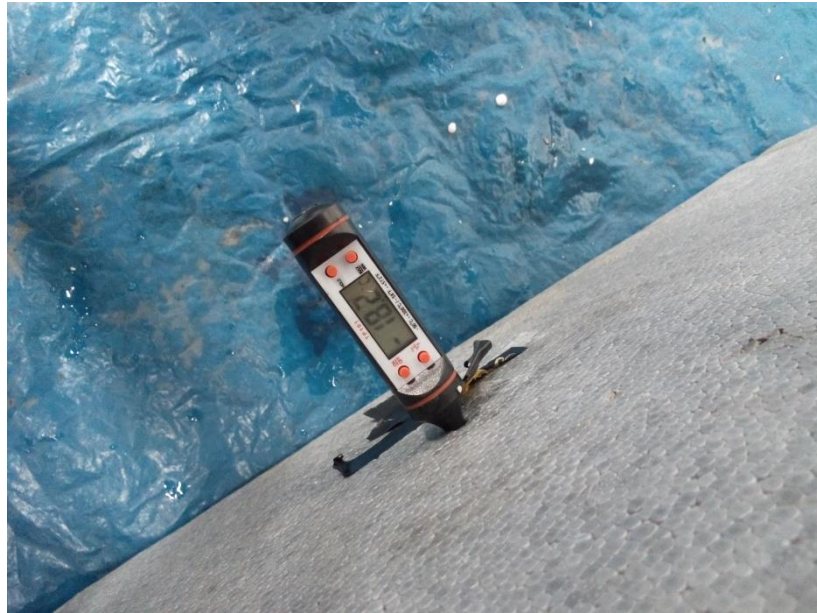
Figura 24: Toma de temperatura en la cámara de refrigeración Fuente: elaboración propia, 2018
