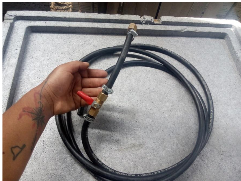
Figura 11: Tubería de alta presión con válvula de cierre Fuente: elaboración propia, 2018
