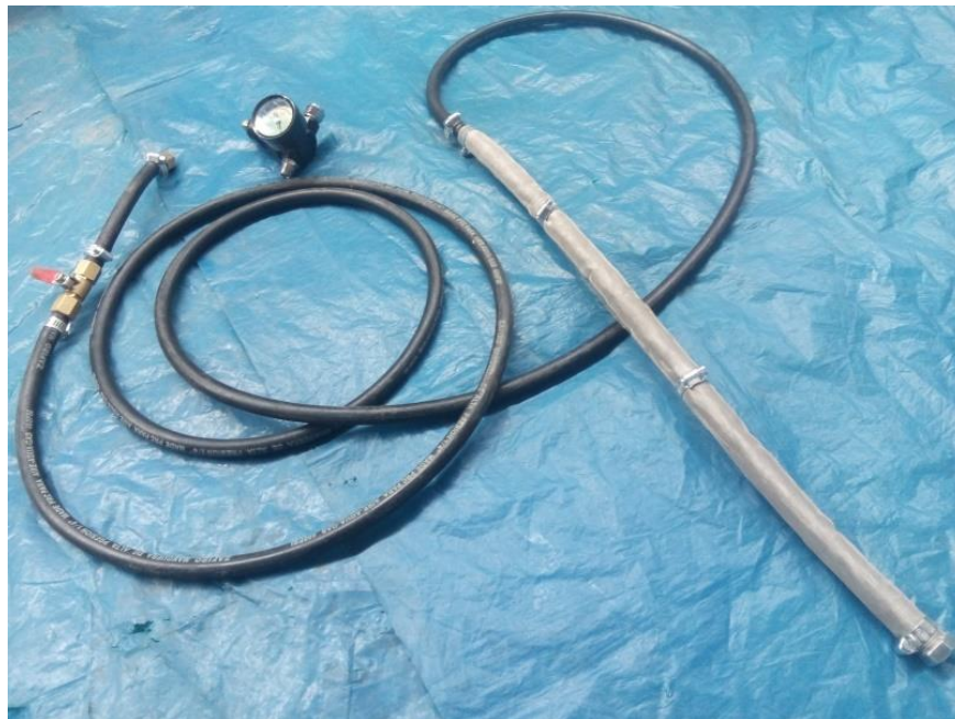
Figura 13: Unión del difusor, manómetro y válvula de cierre Fuente: elaboración propia, 2018
