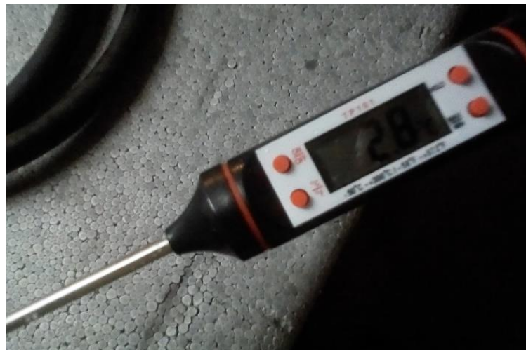
Figura 25: Toma de temperatura en la salida de aire refrigerado Fuente: elaboración propia, 2018
