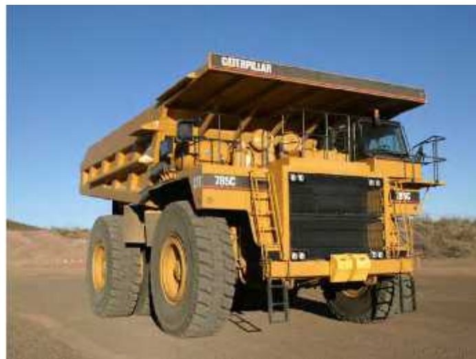
Figura 11: Camión CAT 785C Standard (Tumbay, 2013)
