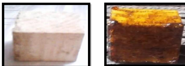
Figura N° 26: Maderas recubiertas con Bioresinas “Sintética y “Protium Sp. Copal”
