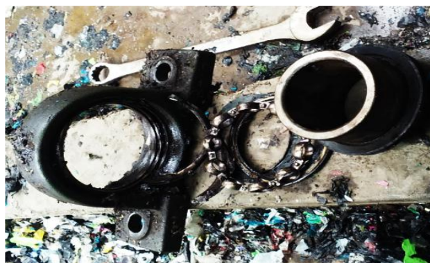
Figura N° 2: Falla en Rodamiento
