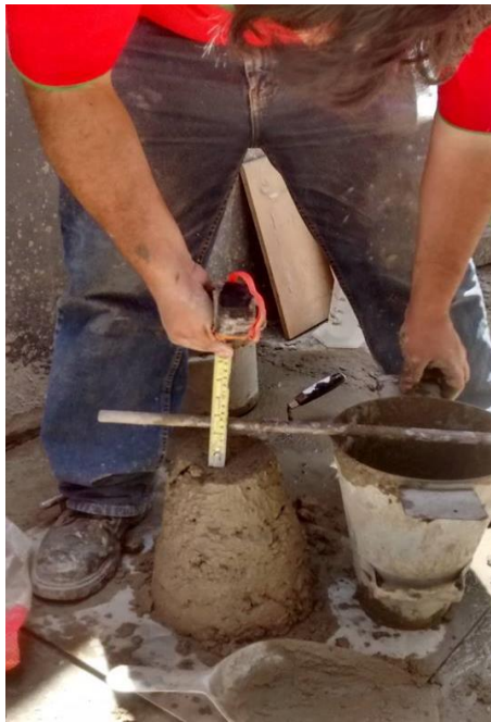
FOTO N°7: Prueba de revenimiento Slump
