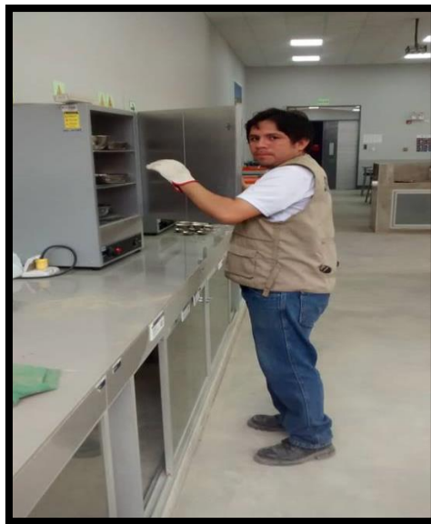
Figura N° 2: Ensayo de contenido de humedad del agregado reciclado
