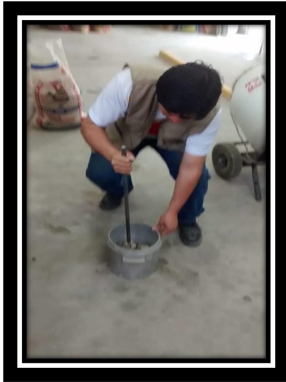
Figura N° 5: Ensayo de Peso unitario compactado del agregado reciclado.
