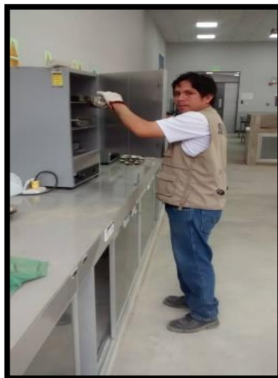
Figura N° 7: Ensayo de contenido de humedad del agregado fino
