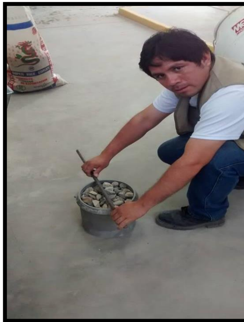
Figura N° 4: Ensayo de Peso unitario suelto del agregado reciclado
