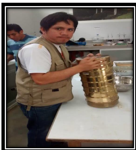
Figura N° 1: Ensayo de Granulometría del agregado grueso reciclado
