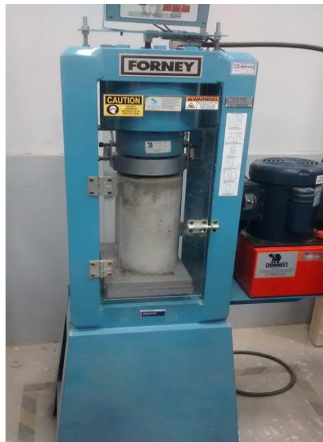
FOTO N°7: Rotura Del Concreto
