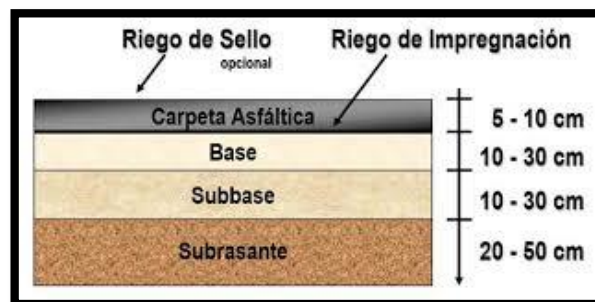
Figura 1.1. Componentes estructurales del pavimento flexible.
