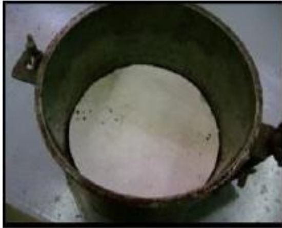
Figura: Disco espaciador y papel filtro dentro del molde.
