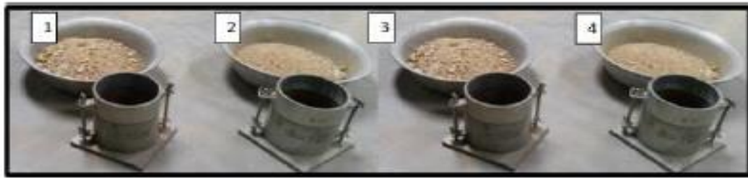
Figura: Muestras y equipos para ensayo de Compactación.
