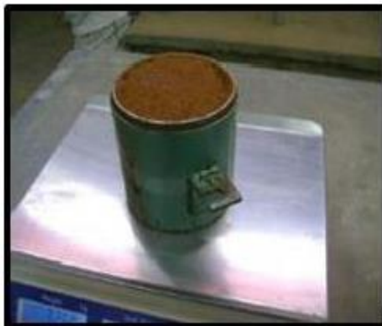
Figura 28: Peso de molde más suelo compactado.
