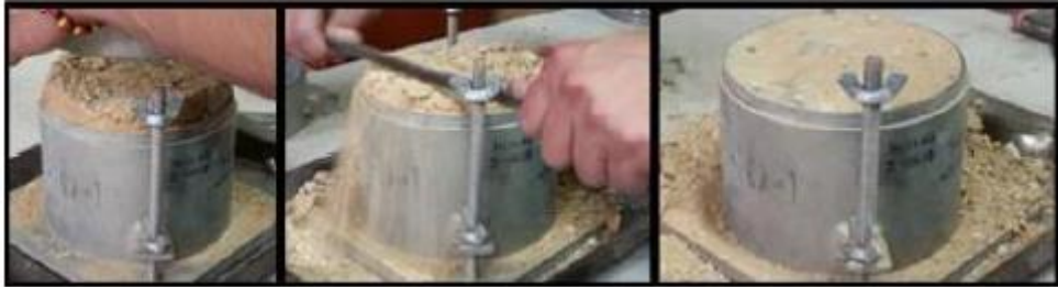
Figura: Enrasado de Muestras compactadas.
