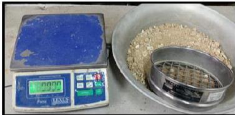
Figura: Tamizado y selección de la muestra.
