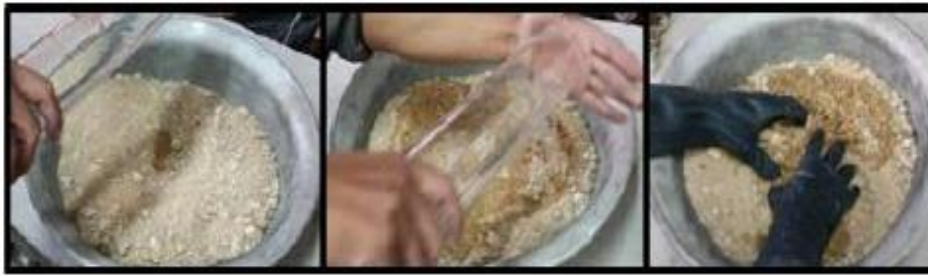
Figura: Amasado para encontrar humedad específica.
