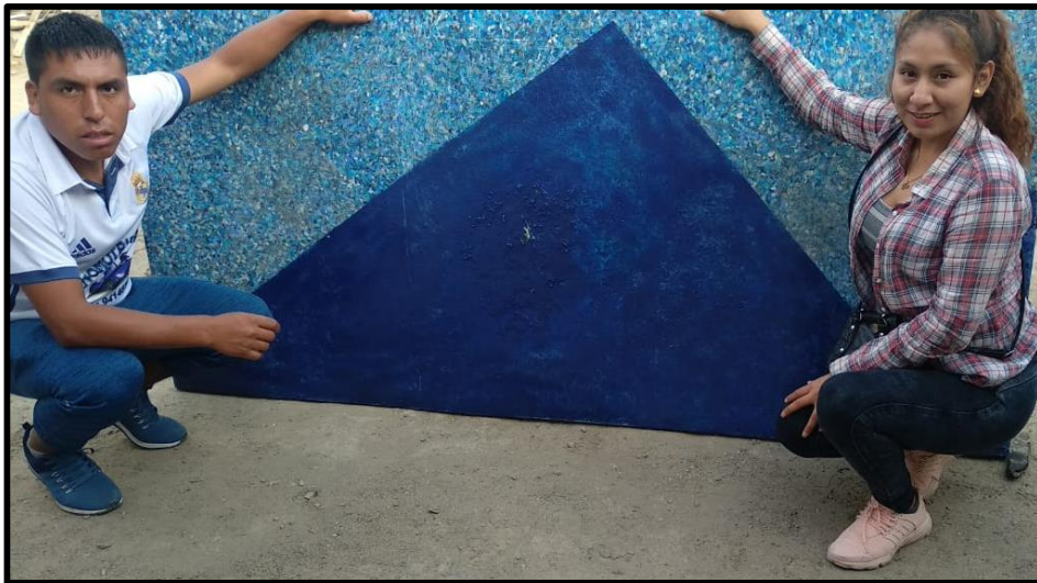
Panel con material reciclado de polipropileno en secciones reales de (2.20 m x1.10 m x 0.12 m)
