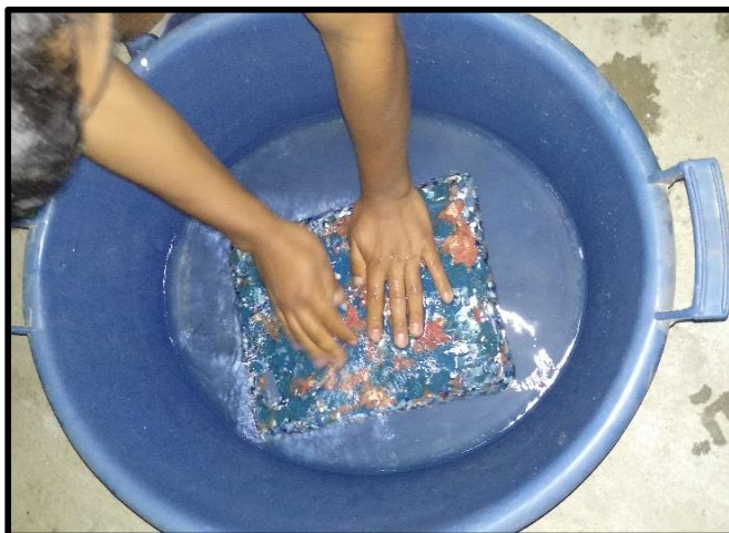
Enfriamiento del producto, es sumergido en un recipiente de agua para facilitar el desprendimiento del productor del molde.
