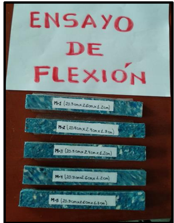
Se observa las 5 muestras que fueron sometidas al ensayo de flexión.
