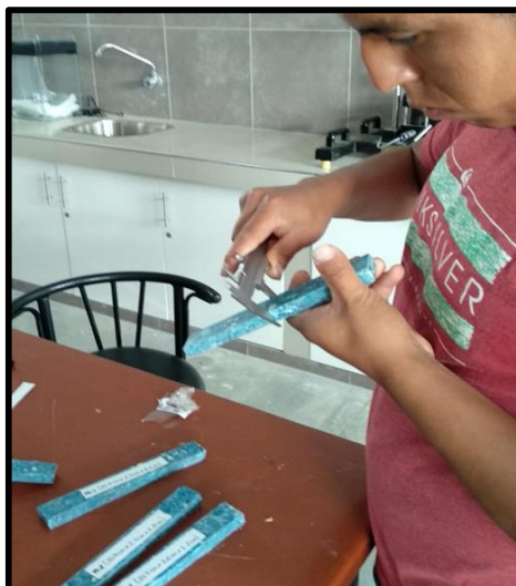
Determinación de los espesores utilizando el vernier.
