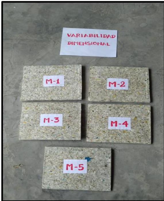
Conformación de las 5 muestras para determinar la variabilidad dimensional de los paneles de PP reciclado.
