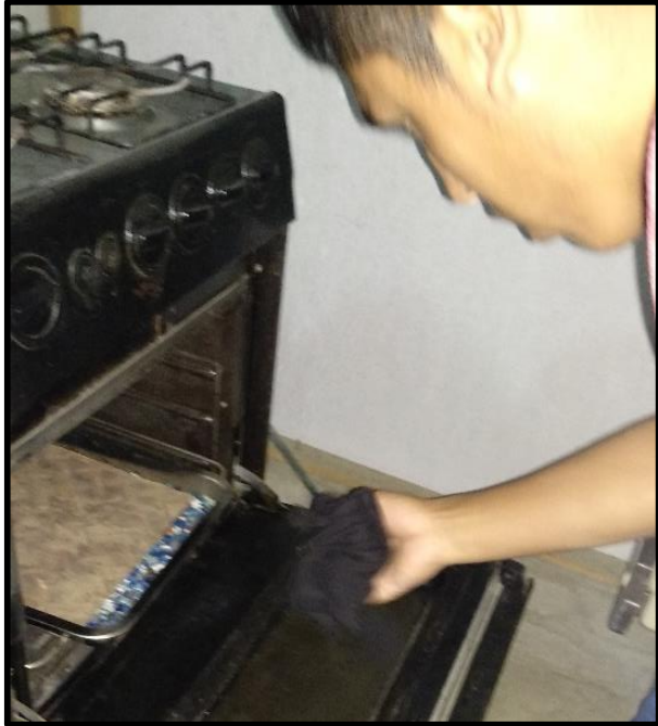
Retirado de la bandeja del horno con el plástico fundido para ser prensado.
