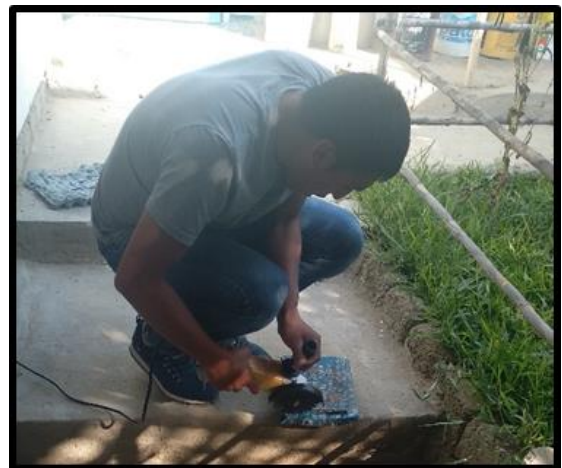
Cortado de bordes para la obtención de las secciones de la muestra.
