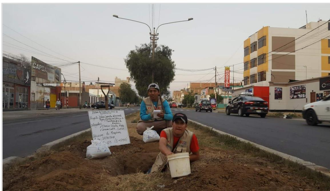
**Figura 81.** Toma de apuntes del perfil estratigráfico de la calicata 03.
