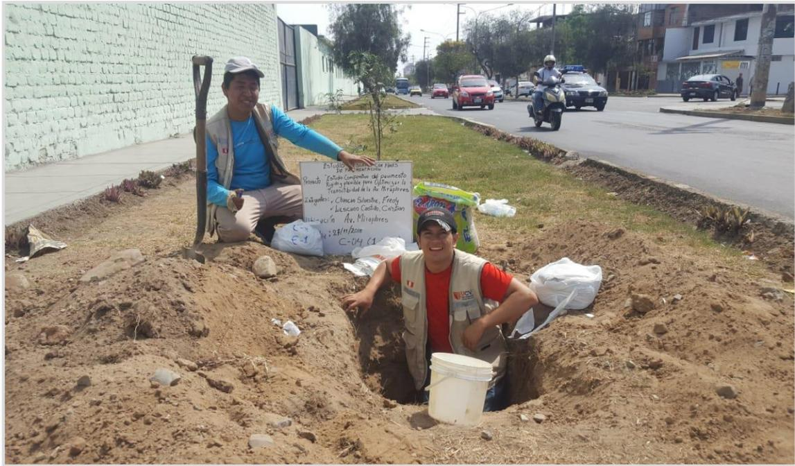
**Figura 82.** Extracción de estratos en la calicata 04.
