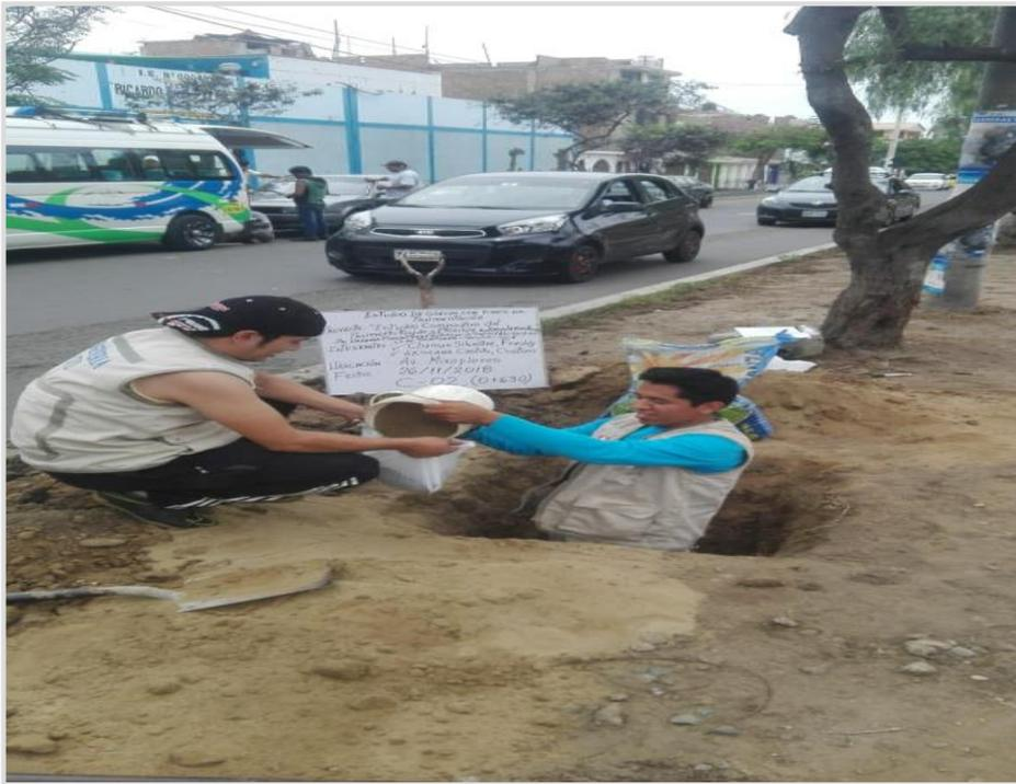
**Figura 78.** Extracción de los estratos para CBR en calicata 02.
