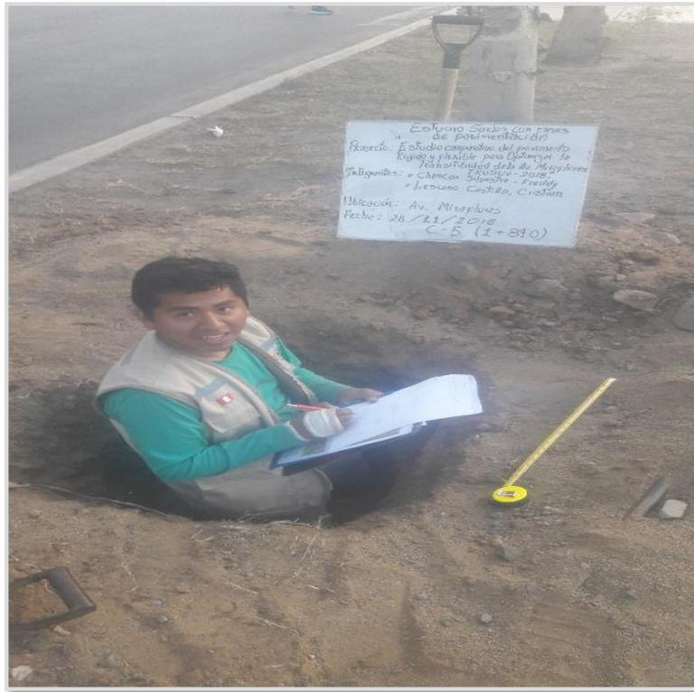
**Figura 84.** Extracción de muestras y bosquejo perfil estratigráfico calicata 05.
