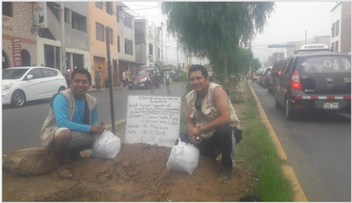
**Figura 76.** Extracción de muestras de estratos en calicata 01.
