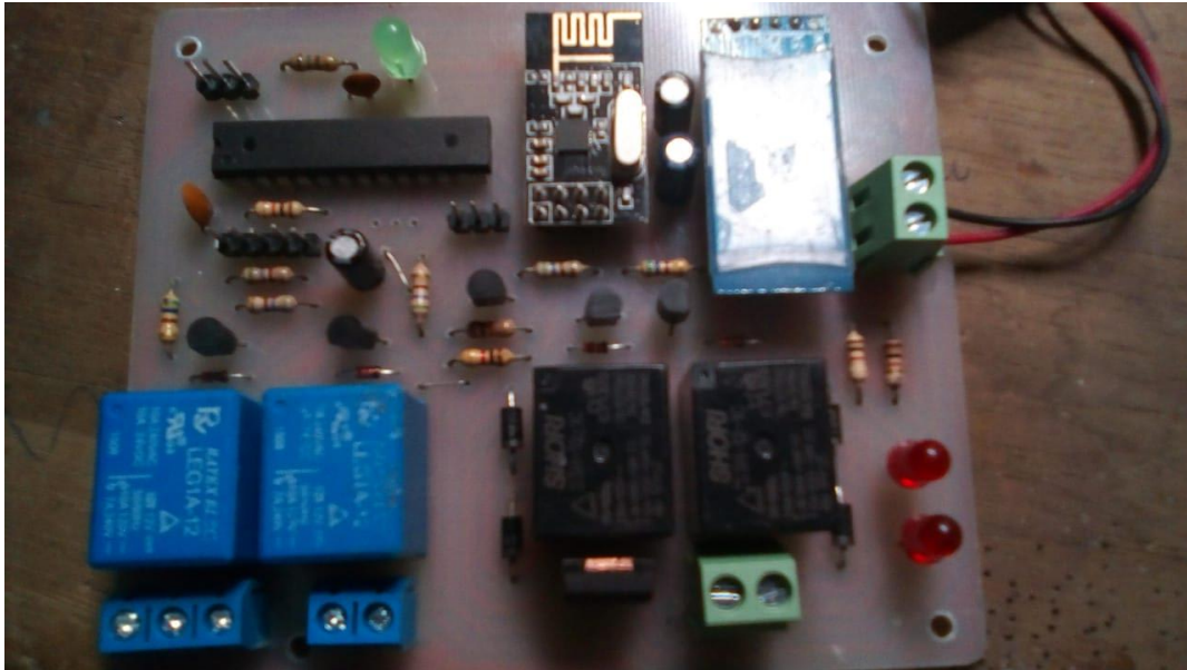
Imagen 13: Componentes electrónicos colocados y soldados en la palca de fibra de vidrio.
