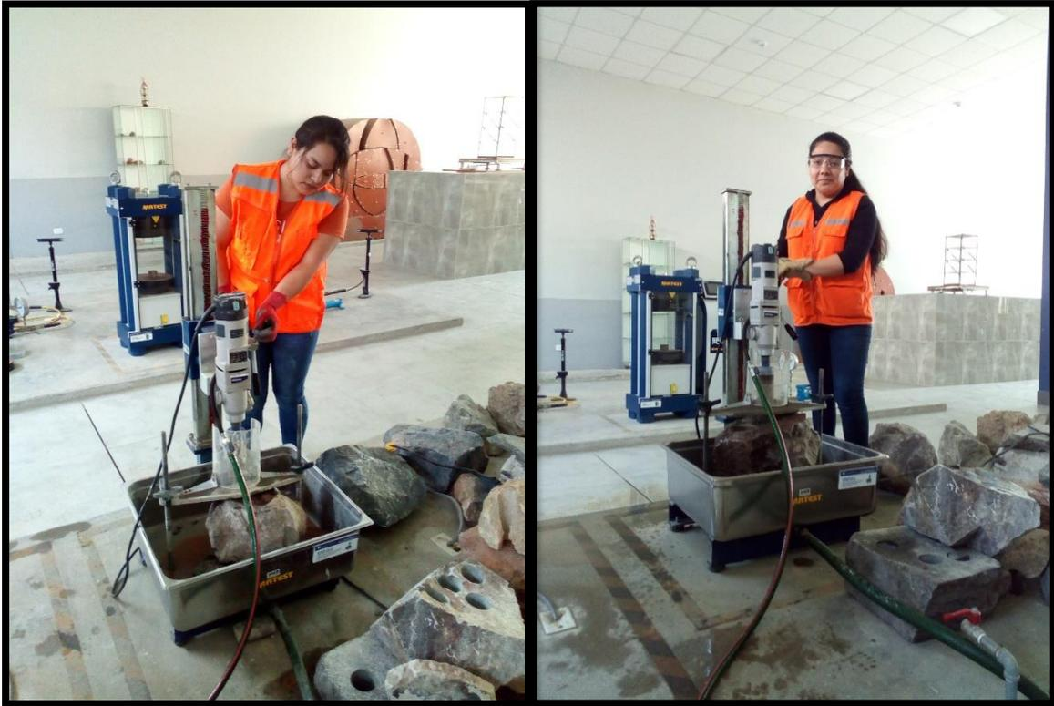
*Figura 11: Máquina saca testigo de núcleo.*
