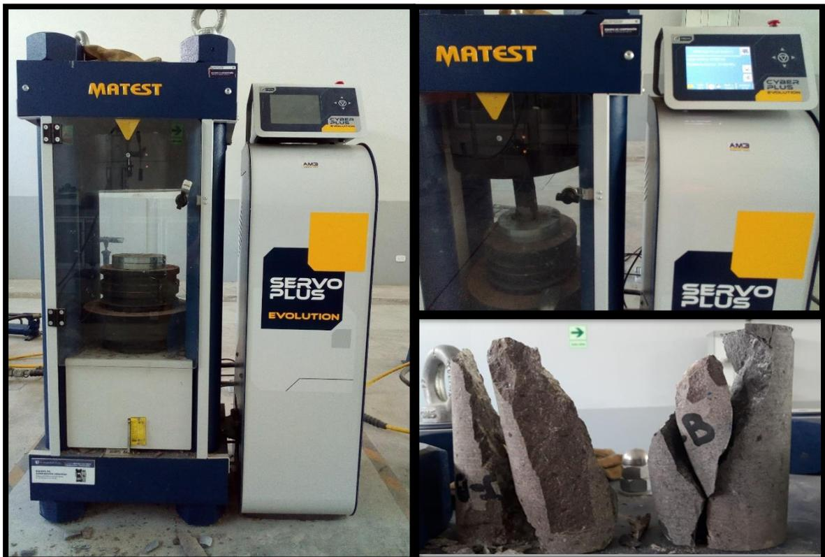
*Figura 14: Equipo de compresión uniaxial.*
