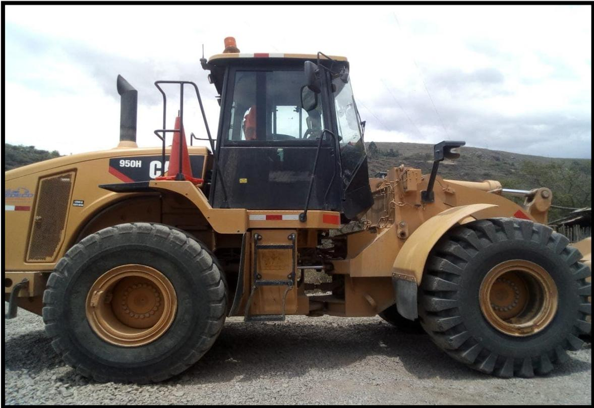
*Figura 3: Maquinaria de carguío – cargador frontal CAT 950H.*
