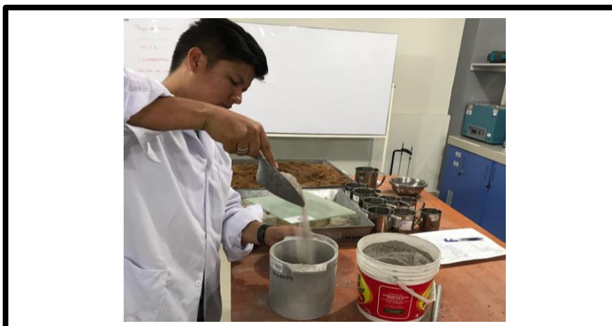
Foto N°09. Estudio de Compactación de confitillo .
