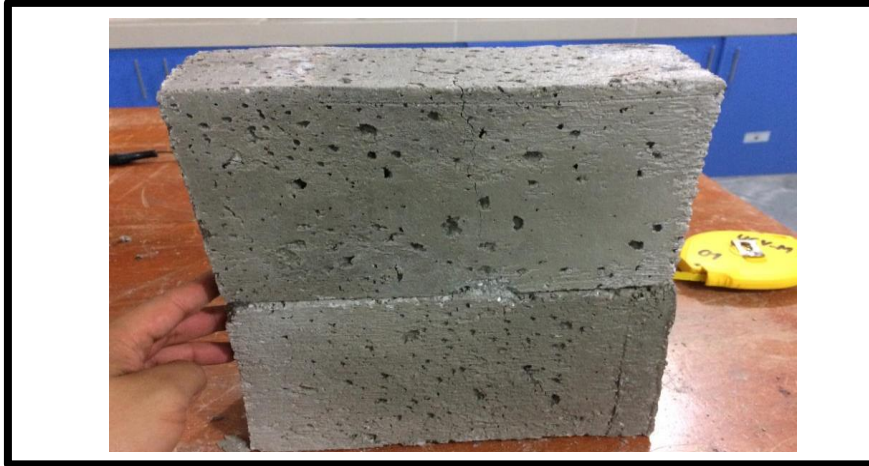
Foto N°13. Resultados sometidos a prueba de compresión del ladrillo de confitillo y cemento.
