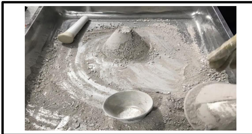
Foto N°08. Resultado del ensayo del Cono de Abrahán.
