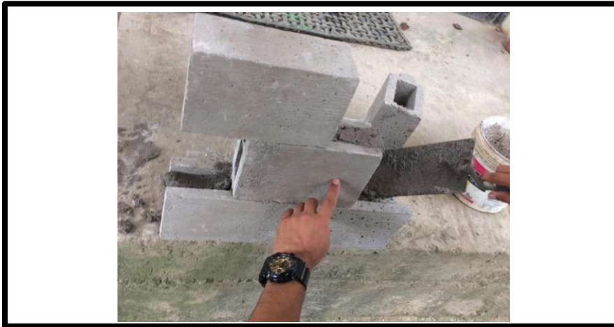
Foto N°16. Resultados de trabajabilidad mediante una prueba práctica con ladrillo de confitillo y cemento.
