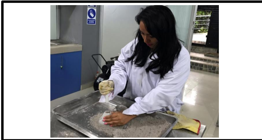
Foto N°07. Ensayo del Cono de Abrahán.
