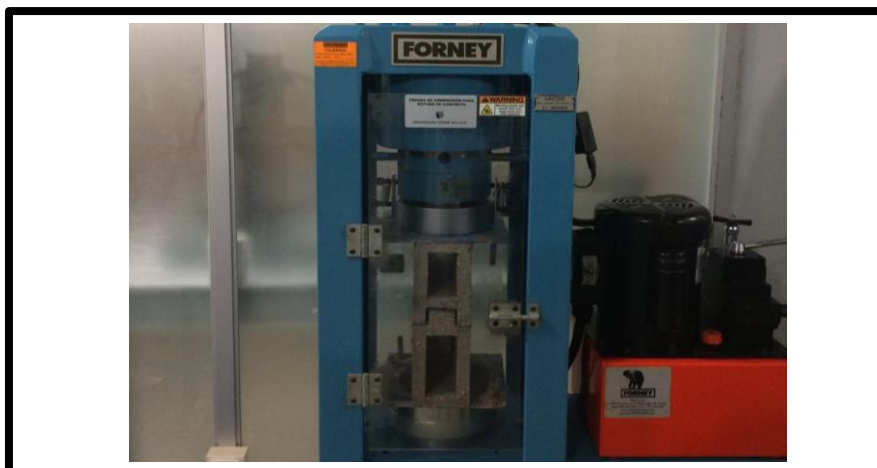
Foto N°12. Prueba de Compresión del ladrillo de confitillo y cemento en laboratorio UCV Moyobamba.
