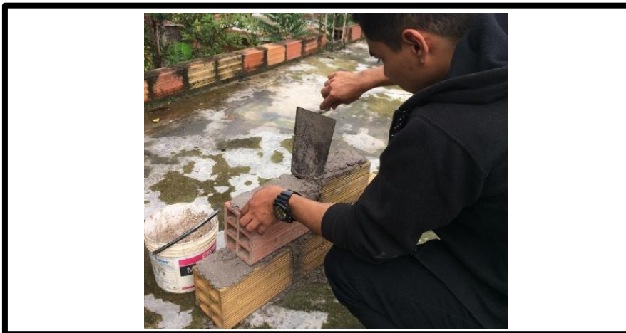
Foto N°17. Resultados de trabajabilidad mediante una prueba práctica con ladrillo pandereta.
