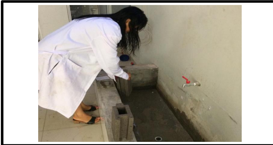
Foto N°14. Prueba de humedad del ladrillo reposando en agua 24 horas.
