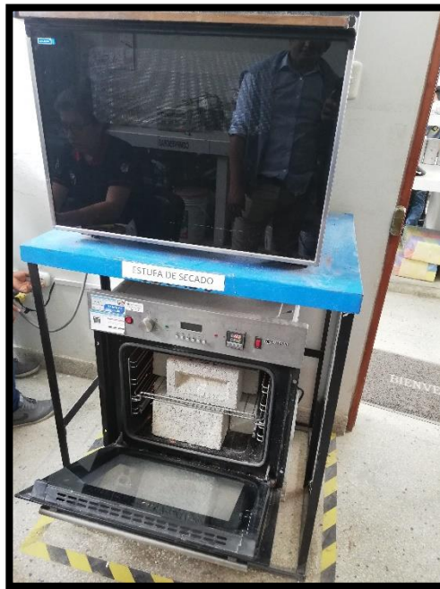
Figura 50. Estufa donde se realizará el secado de los bloques.
