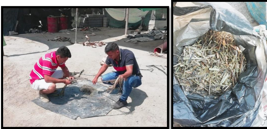
Figura 32. Habilitación de la fibra del Vástago del Plátano para la elaboración de los ladrillos.
