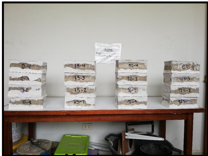
Figura 45. Bloques codificados para ensayo a compresión.
