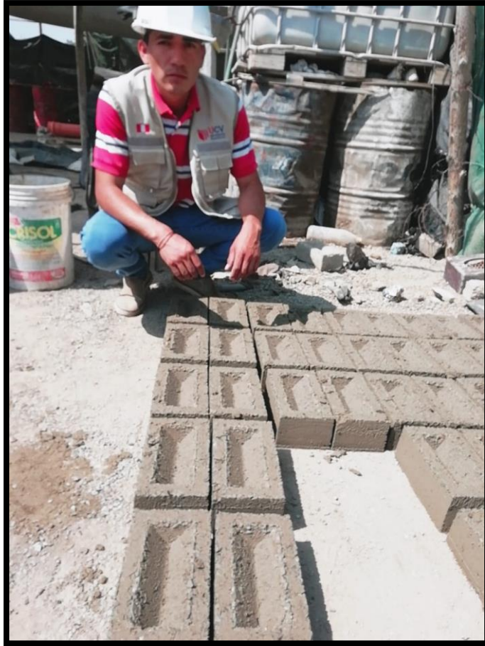
Figura 36. Ladrillos de concreto ya elaborados.
