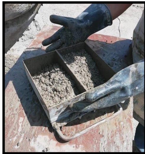
Figura 35. Colocación de la mezcla de concreto en el molde, por capas.
