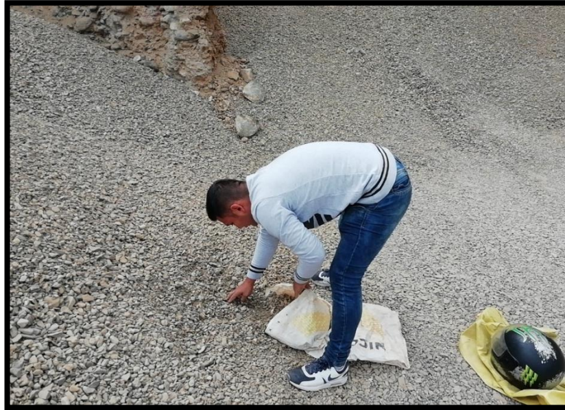
Figura 28. Extracción de agregado Grueso.
