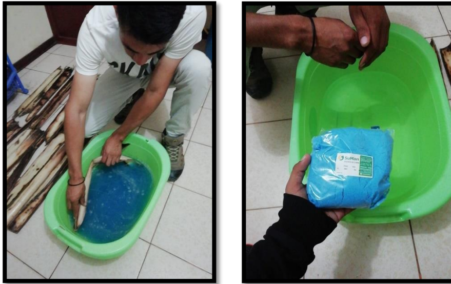
Figura 26. Tratamiento con Sulfato de Cobre a la fibra del Vástago del Plátano.
