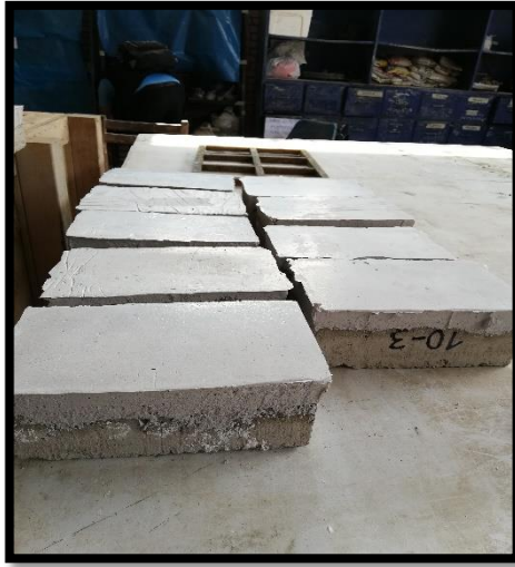
Figura 42. Colocación de yeso previo al ensayo de compresión.
