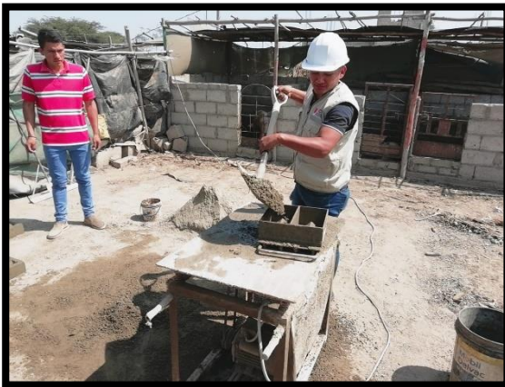
Figura 35. Colocación de la mezcla de concreto en el molde, por capas.
