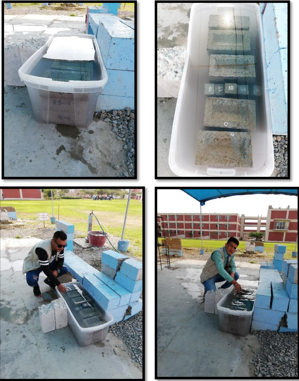
Figura 48. Saturación de bloques por 48 horas.
