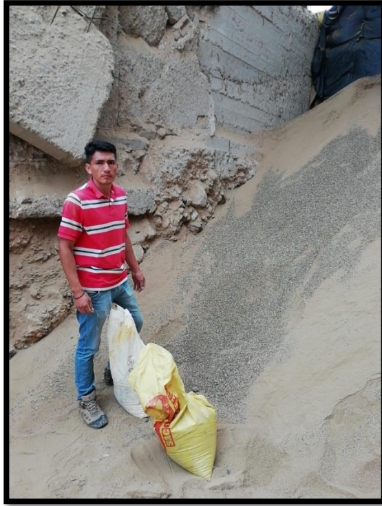
Figura 30. Extracción de agregado Fino.
