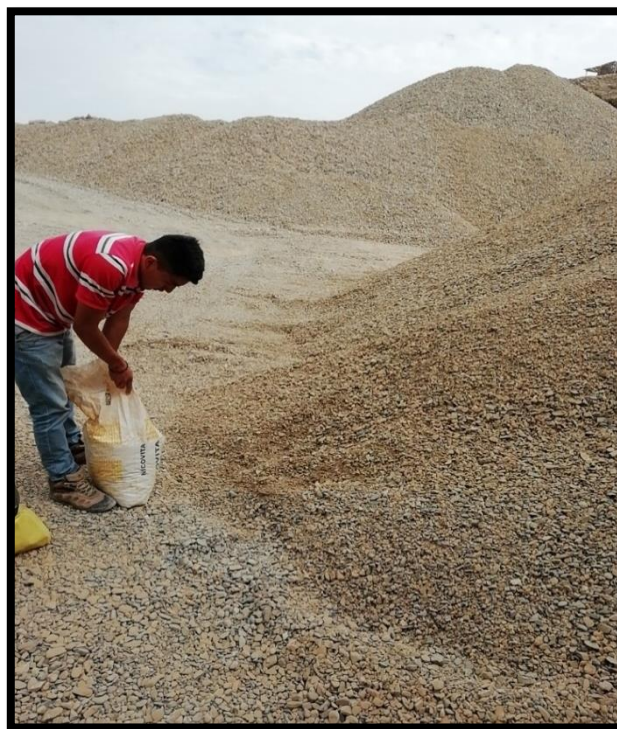
Figura 29. Extracción de agregado grueso.
