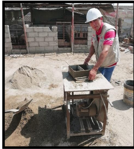
Figura 34. Habilidad del molde metálico para la elaboración de los ladrillos.
