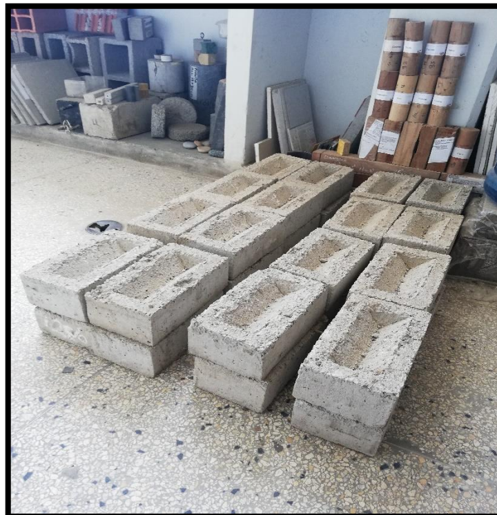
Figura 41. Bloques apilados en orden de 0%, 7.5%, 10% y 12.5% de fibra de plátano.
