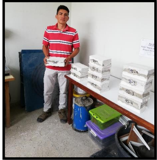
Figura 46. Bloques de concreto antes de ser ensayados a compresión.
