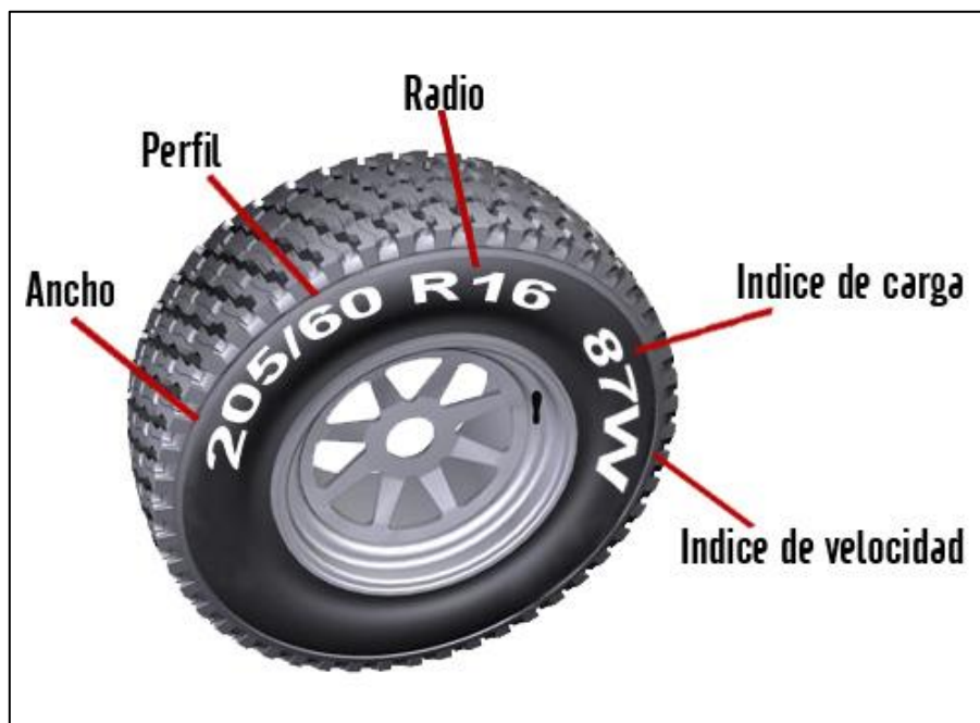
Figura 4. Dimensiones y características de un neumático
