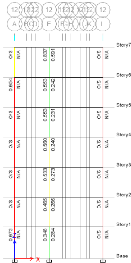
Figura 41. La imagen representa la relación en pórticos que son menores a 1, que la columna es fuerte y viga débil y de que o/s interpreta que requiere más cuantía de acero longitudinal (ETABS 2016).
