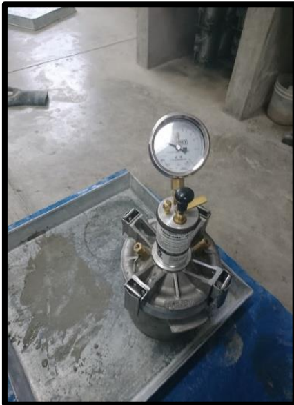
Figura 24. Control de características del concreto en estado fresco y vaciado de probetas
