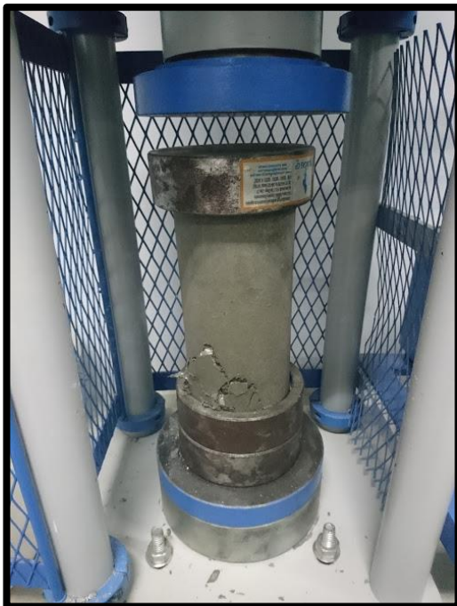
Figura 25. Ensayo de resistencia a la compresión y flexión para el concreto modificado
