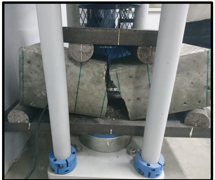
Figura 25. Ensayo de resistencia a la compresión y flexión para el concreto modificado
