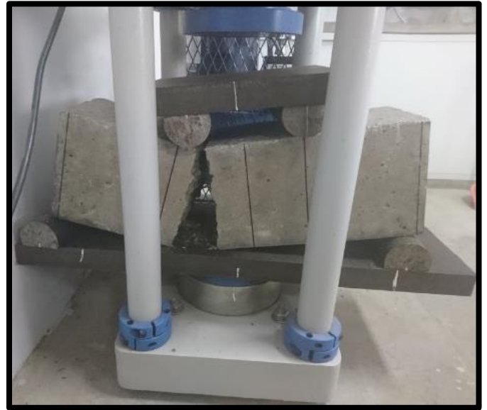
Figura 24. Ensayo de resistencia a la compresión y flexión para el concreto convencional
