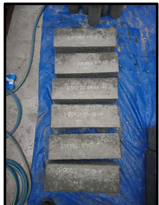
Figura 23. Probetas de concreto modificado para resistencia a la compresión y flexión
