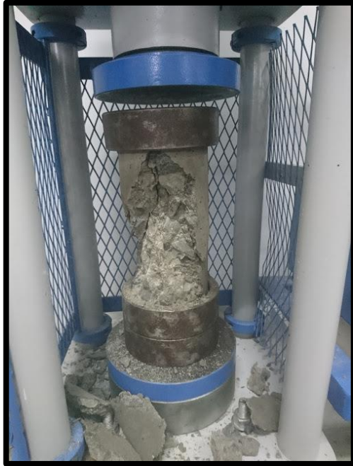
Figura 24. Ensayo de resistencia a la compresión y flexión para el concreto convencional
