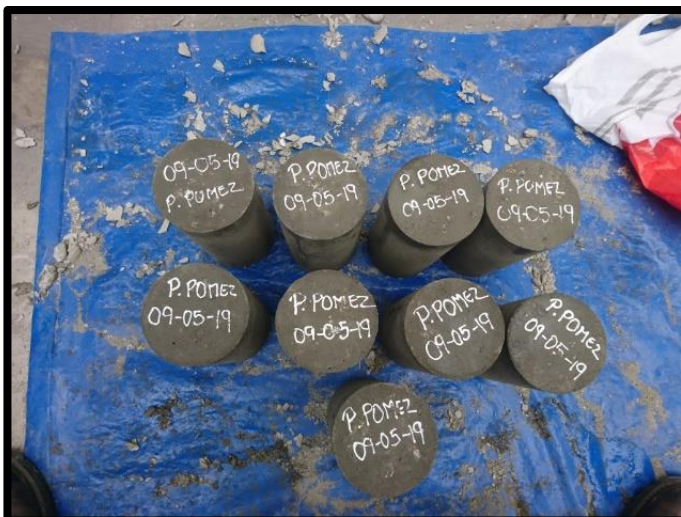
Figura 23. Probetas de concreto modificado para resistencia a la compresión y flexión
