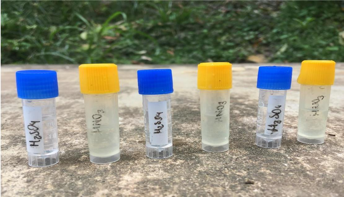
**Foto 9:** Reactivos de preservación H<sub>2</sub>SO<sub>4</sub> y HNO<sub>3</sub>.
