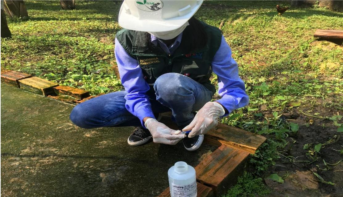
**Foto 5:** Aplicación del reactivo  $\text{HNO}_3$  en el manantial La Banda P1 del barrio Suchiche.
