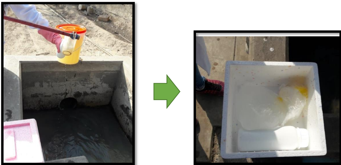
Figura 7 Toma de muestra del PTAR UNI
