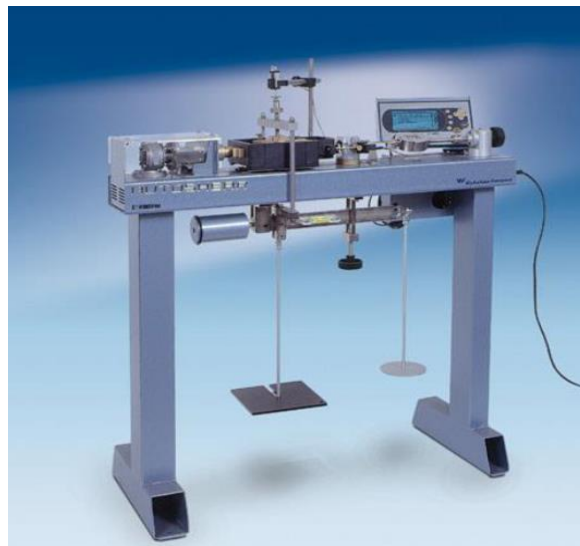
Figura 15: Equipo actualizado de corte directo Fuente: (Ravines Aliaga, 2017, pág. 26)
