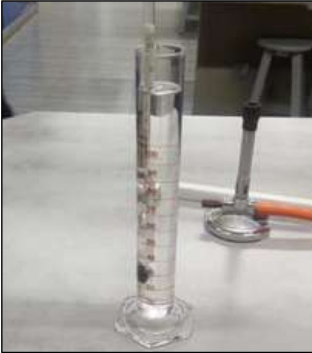
Imagen N°14: Medición del grado alcohólico
