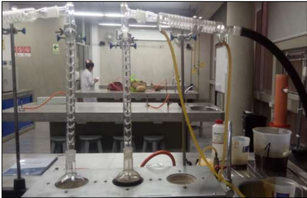
Imagen N° 10: Instalación del equipo de destilación fraccionada
