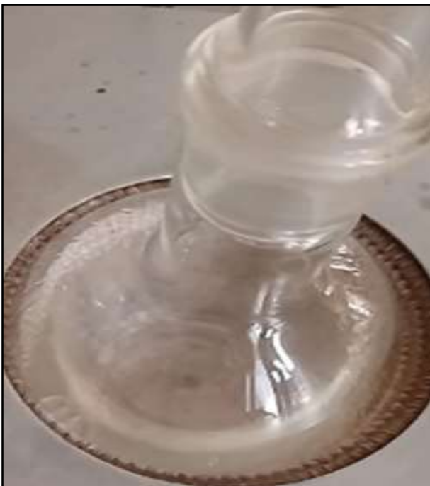
Imagen N°16: Ebullición del alcohol a 65°C
