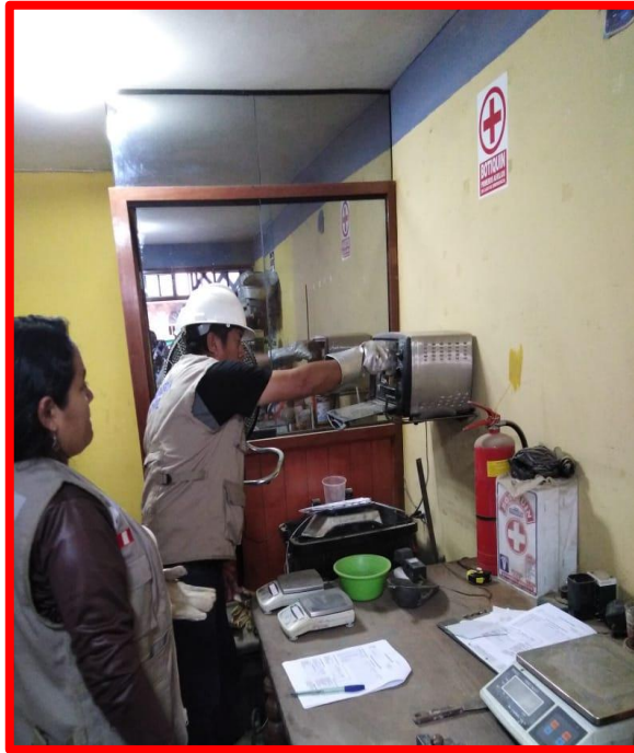
secado al horno de una muestra significativa para el ensayo de Próctor Modificado
