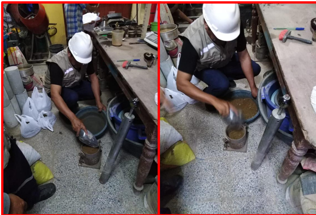
Llenado el molde del Próctor con la muestra al 3% de humedad
