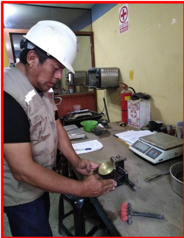
Peso de la muestra compactada en el molde de CBR.
