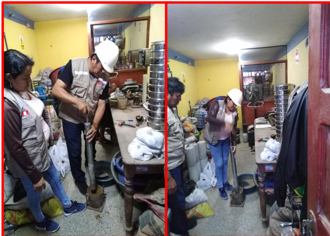
Realizando la serie de golpes a la muestra con el Próctor Modificado.
