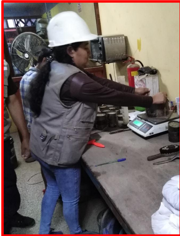
Peso de la muestra compactada en el molde de CBR.
