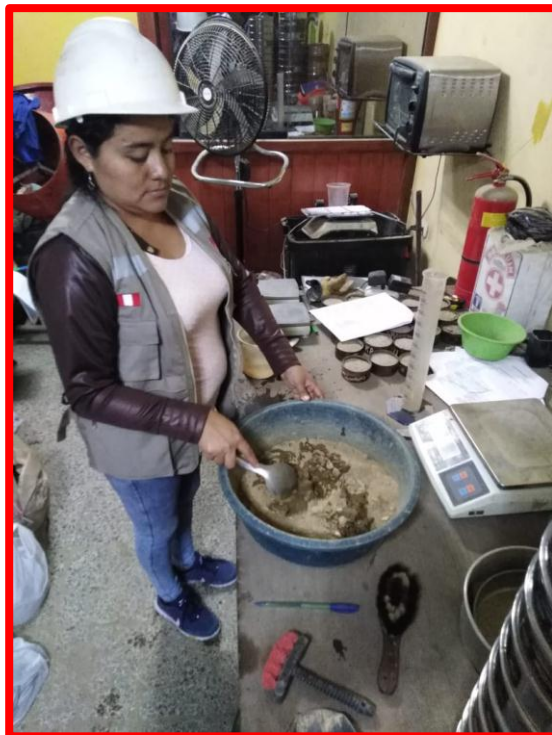
Homogenizando la muestra con el agua de 3% para el cálculo CBR
