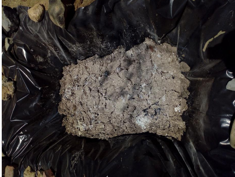
Foto 27: homogenización de la cal viva con el lodo residual.
