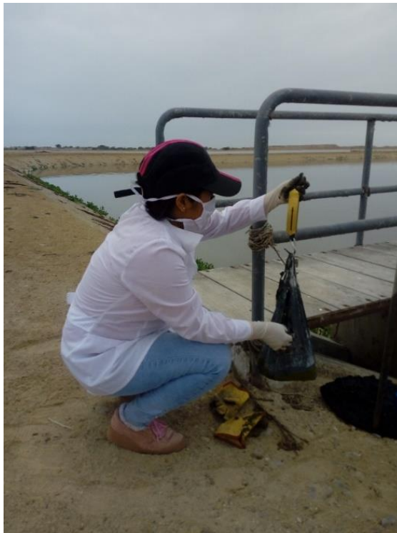
Foto 6: pesado de la muestra de lodo residual.
