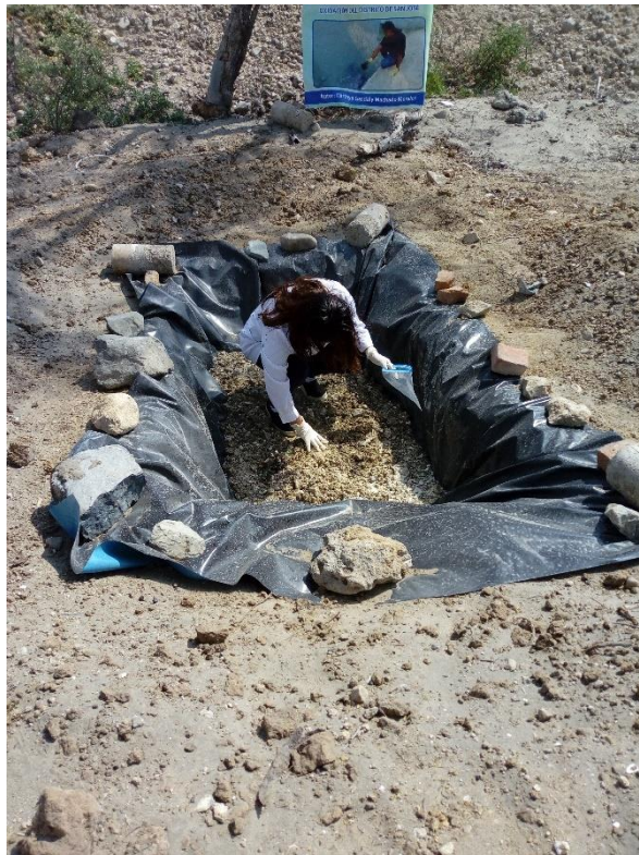
Foto 29: toma de la muestra de lodo residual con cal viva.
