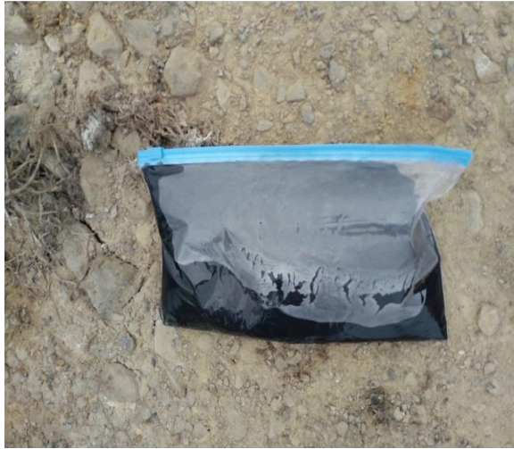
Foto 7: la muestra de lodo residual en bolsa hermética para llevar a laboratorio.
