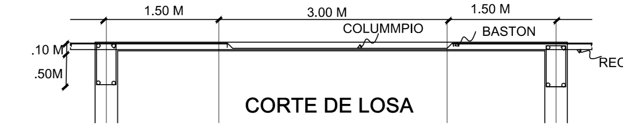
CORTE DE LOSA
