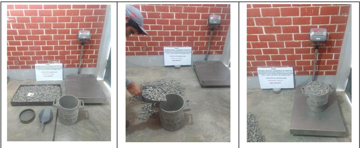
**Figura N° 25: Peso unitario suelto de agregado grueso**
