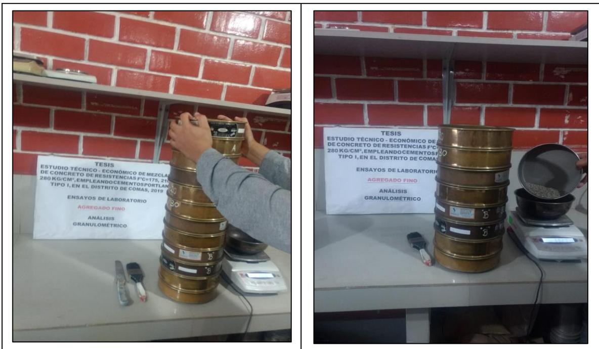
*Figura N° 20: Análisis granulométrico por tamizado agregado fino*
