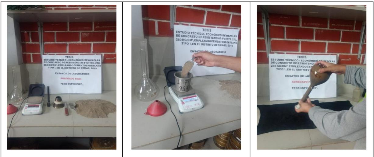
**Figura N° 27: Peso específico agregado fino**
