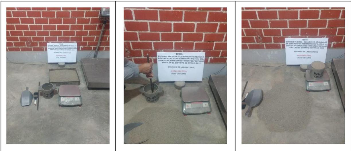
**Figura N° 24: Peso unitario varillado de agregado fino**
