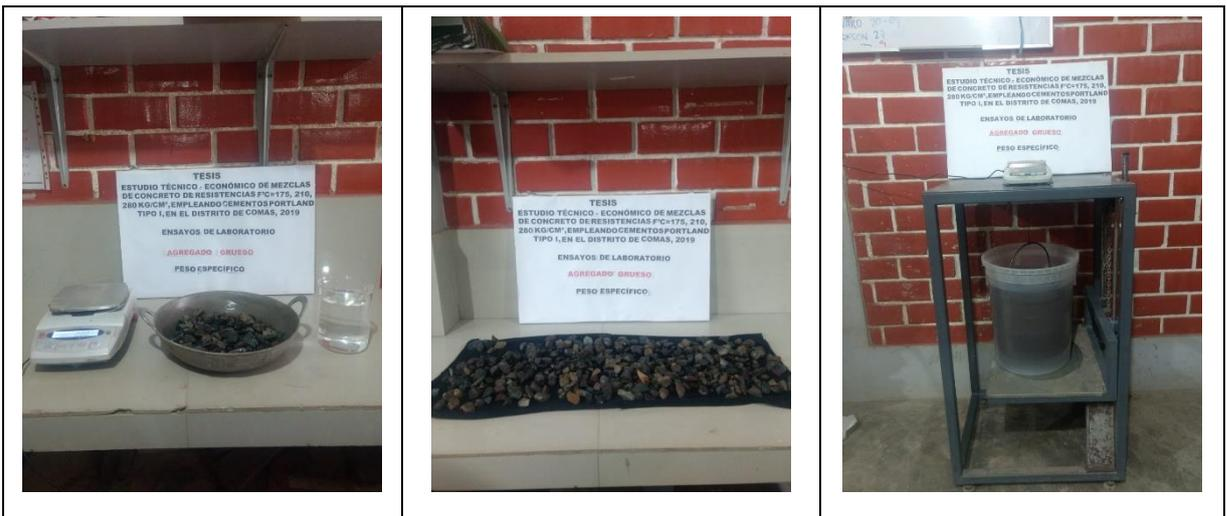
**Figura N° 28: Peso específico agregado grueso**
