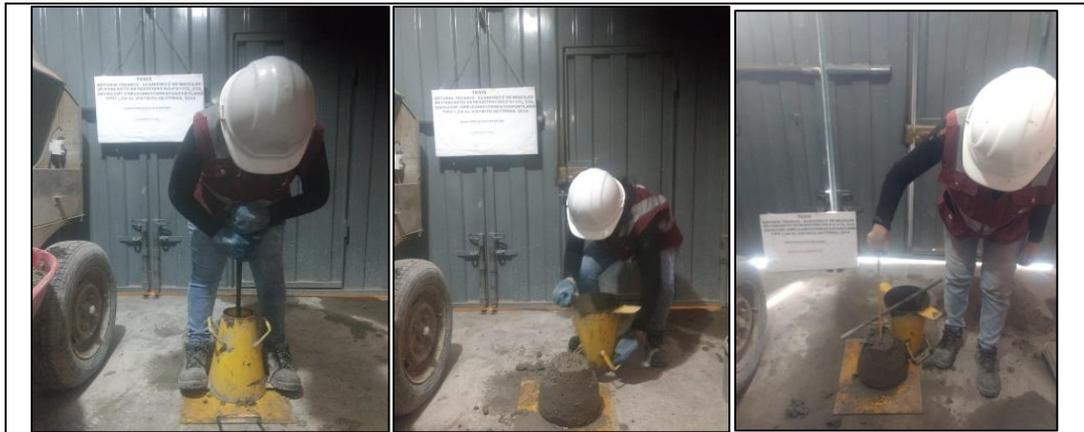
*Figura N° 4: Asentamiento del concreto (Slump)*
