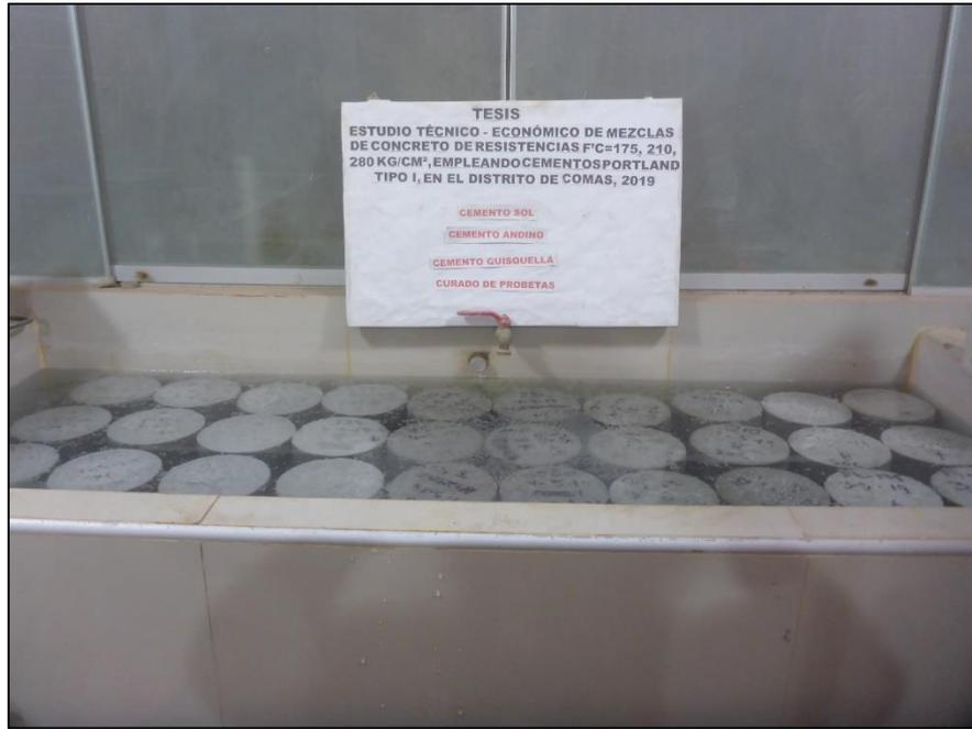
**Figura N° 33: Curado de Probetas**
