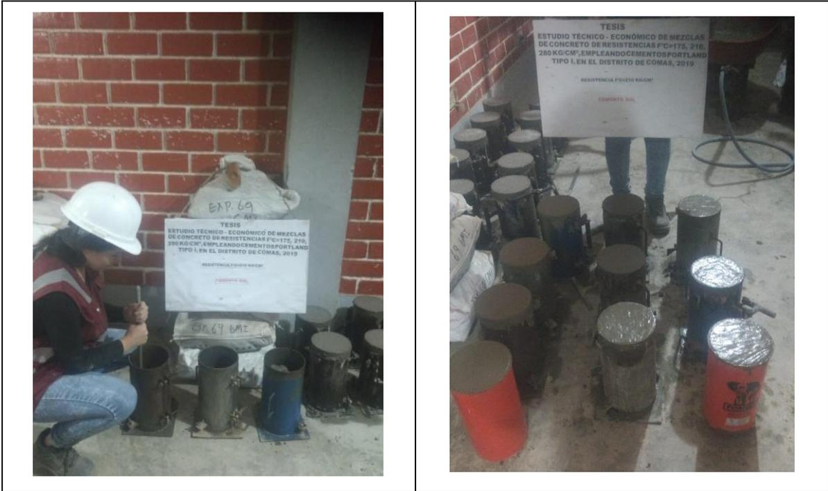
**Figura N° 29: Moldelación de probetas cilíndricas**
