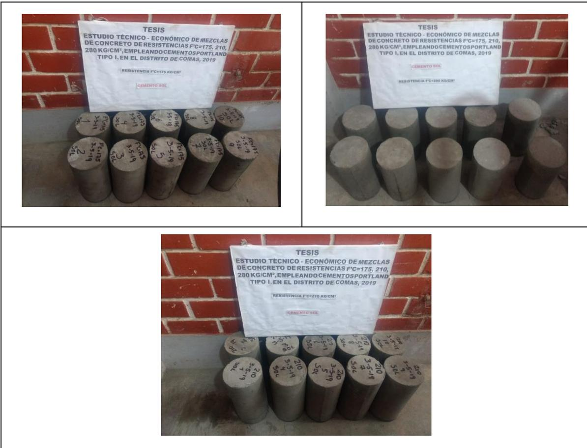
**Figura N° 30: Probetas de Cemento Sol**
