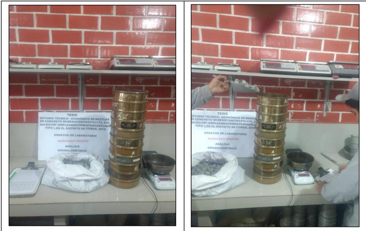
*Figura N° 21: Análisis granulométrico por tamizado agregado grueso*
