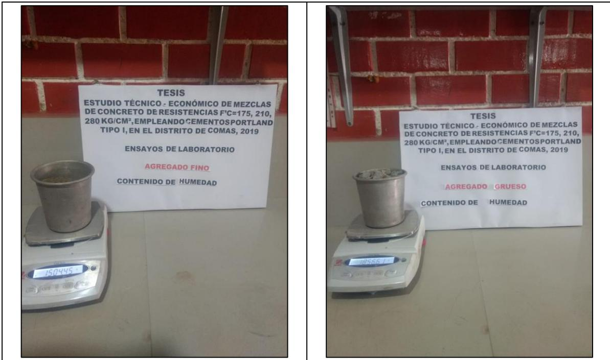
*Figura N° 22: Contenido de humedad de agregado fino y grueso*
