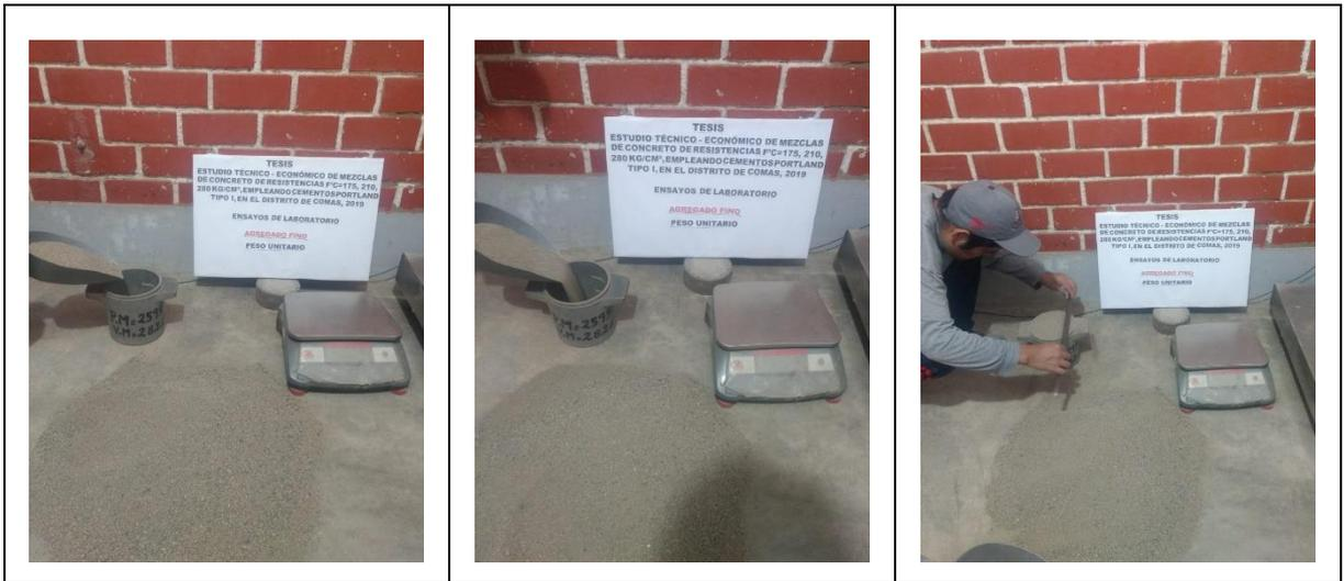
**Figura N° 23: Peso unitario suelto de agregado fino**
