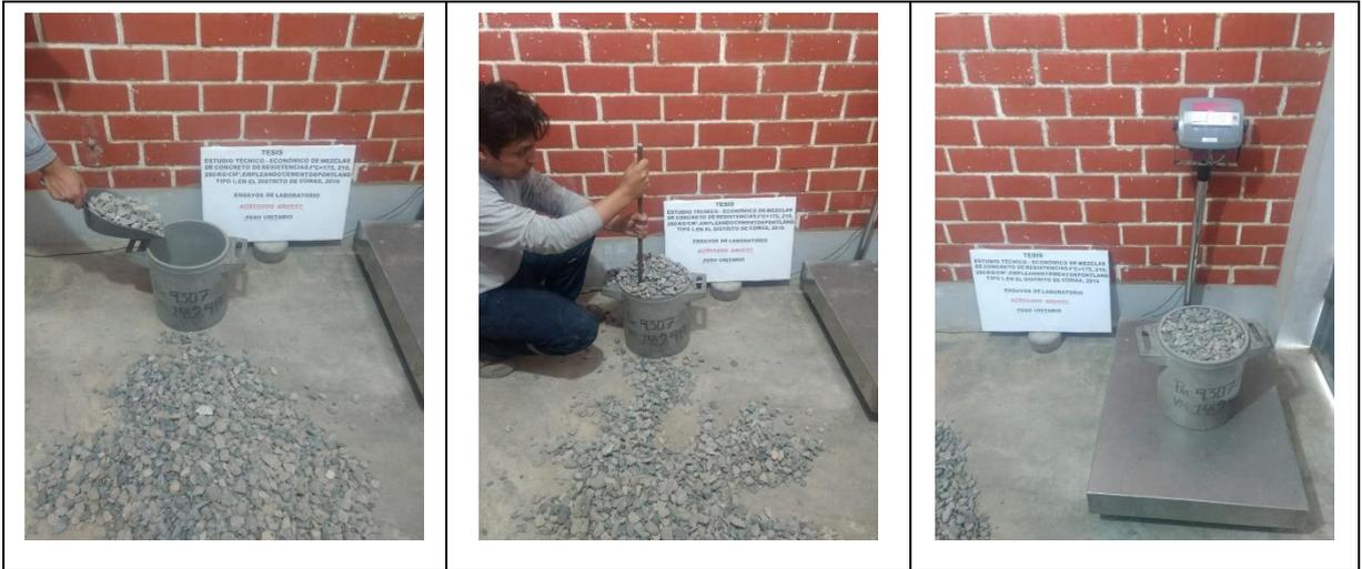
**Figura N° 26: Peso unitario varillado de agregado grueso**
