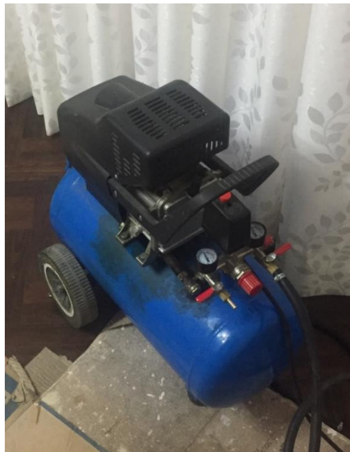
Figura 12: Bomba de aire la cual va conectada con equipo generador de microburbujas.
