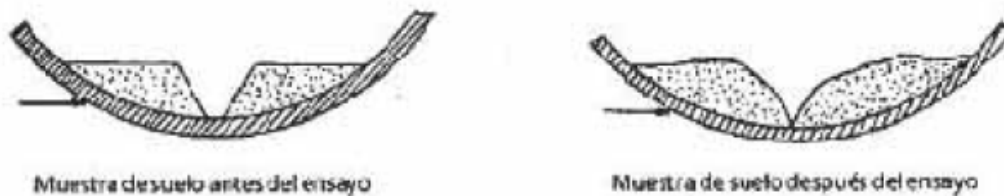
Figura 3. Diagrama ilustrativo del ensayo de límite líquido.
