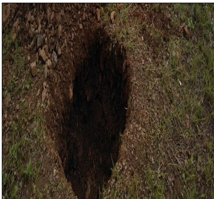
FOTO 07: SE OBSERVA LA EXCAVACIÓN CALICATA C-01.
