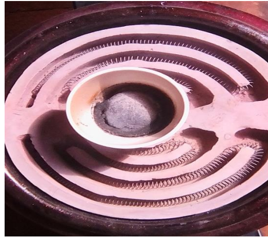
5g de Nostoc sphaericum (Cushuro) deshidratado y pulverizado en un crisol y puesto a fuego (Pre Ceniza)
