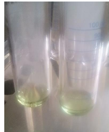
Figura k. Termino de digestión del tubo sea un líquido transparente nítido con coloración azul claro, verde o amarillo –
