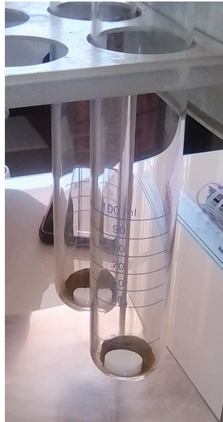
Figura i. Adición de 5g de catalizador al Nostoc sphaericum (Cushuro) en el tubo digestión
