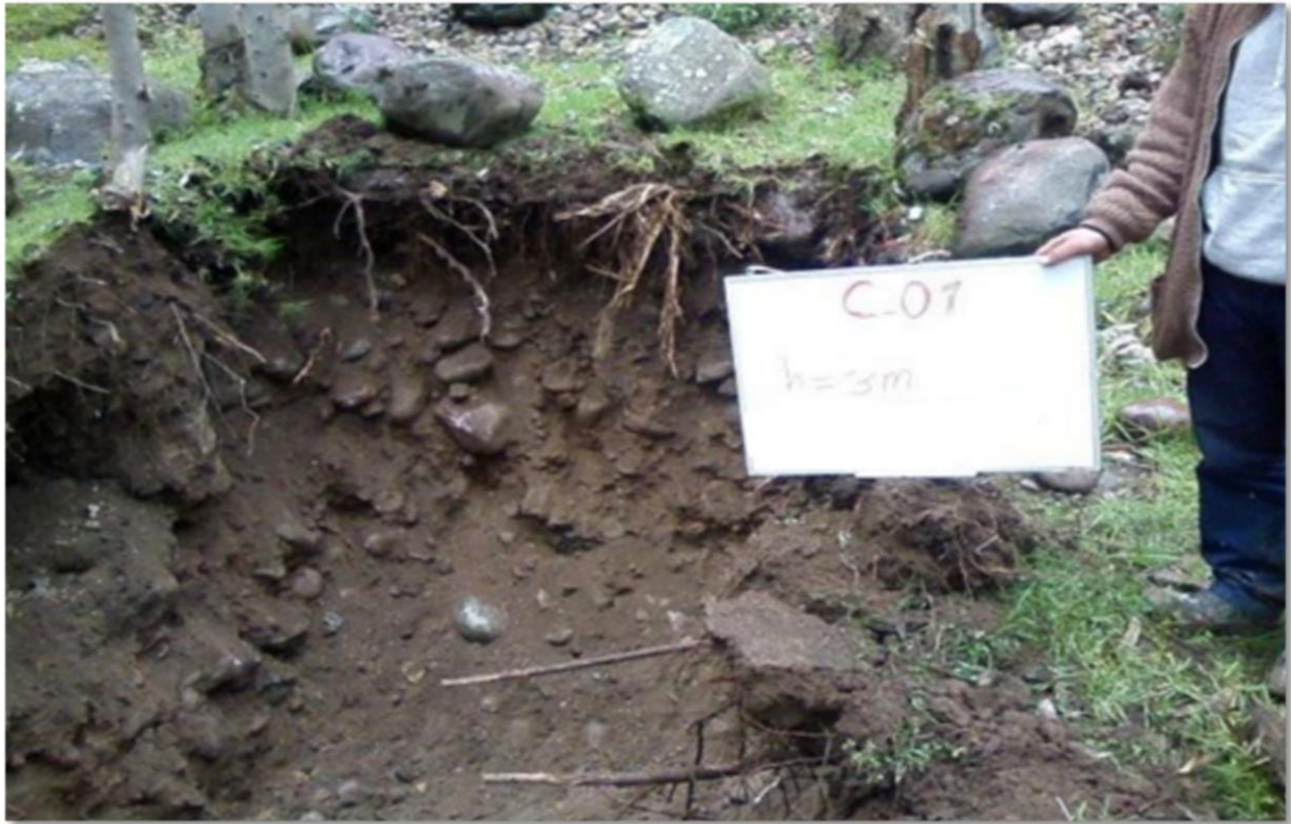
Fotografía 01: Extracción de muestra, calicata N° 01, progresiva 5 + 580, profundidad 3 m.
