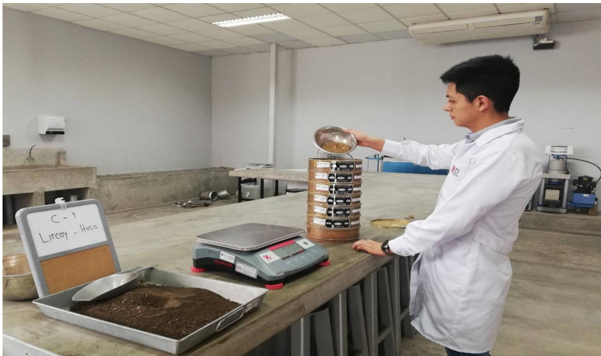
Fotografía 08: Realizando el tamizaje con las muestras para los análisis Granulométricos.
